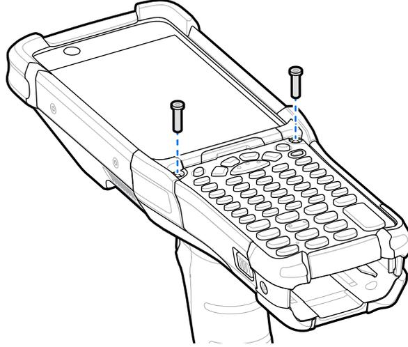
6. ارفع لوحة المفاتيح من الجهاز لكشف حامل بطاقة microSD.
