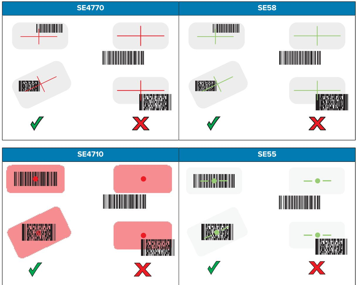
Abbildung 17 Entnahmelistenmodus mit mehreren Barcodes im Zielmuster
