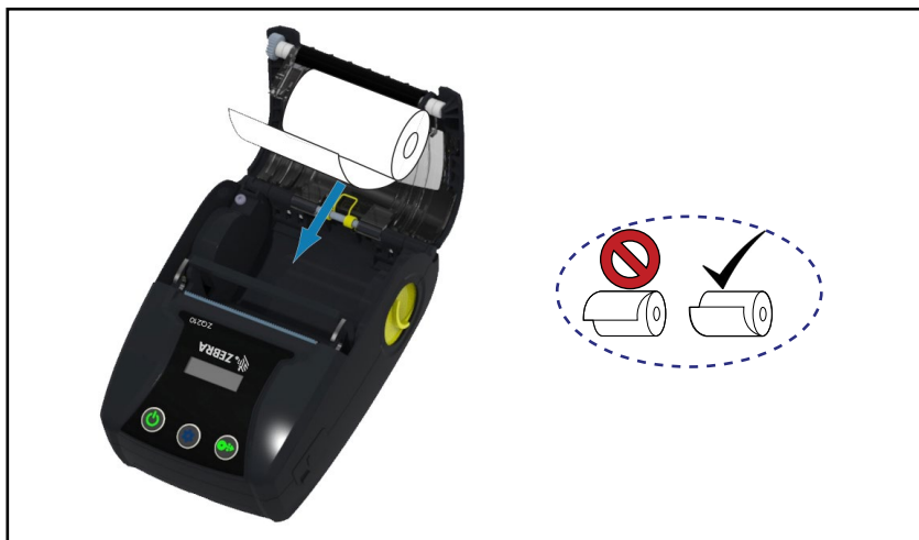
Figura 4 • Carga del papel (continuación)
