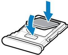
4. Presione la tarjeta SIM hacia abajo para insertarla en el soporte de tarjetas y asegúrese de que encaje correctamente.
