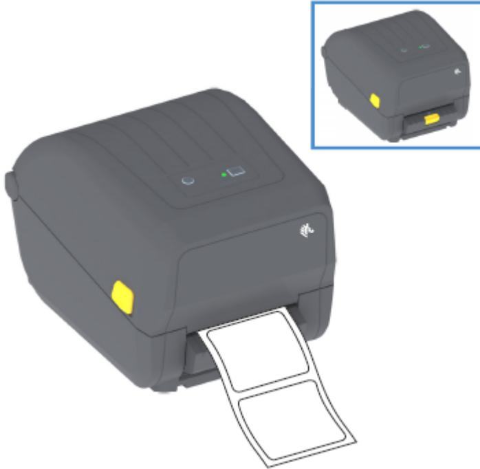
3. Levante el revestimiento sobre la parte superior de la impresora y luego tire del seguro dorado en el centro de la puerta del dispensador lejos de la impresora.
