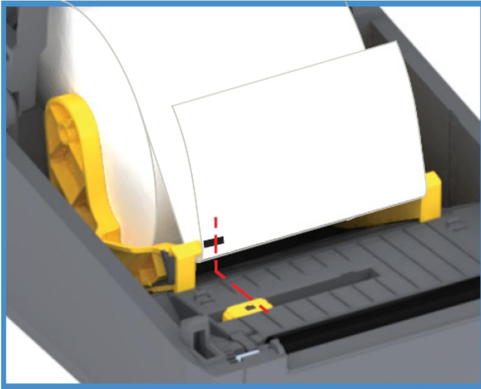
Al imprimir, los medios se pueden mover de lado a lado  $\pm 1$  mm (debido a variaciones de medios y daños en los bordes debido a la manipulación). Las muescas cortadas en el costado del medio también se pueden dañar.
