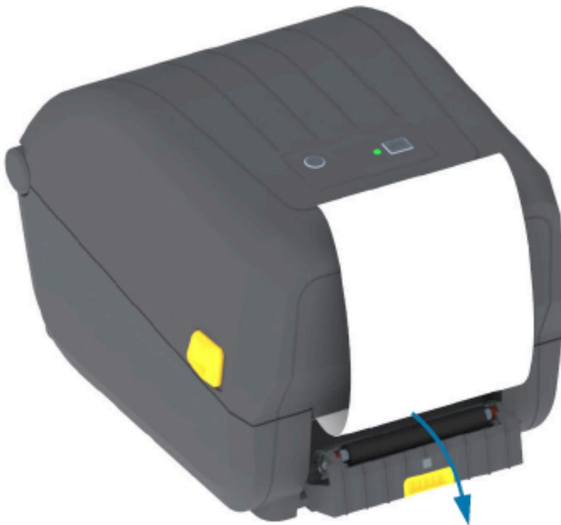
4. Inserte el recubrimiento de la etiqueta entre la tapa del dispensador y el cuerpo de la impresora.
