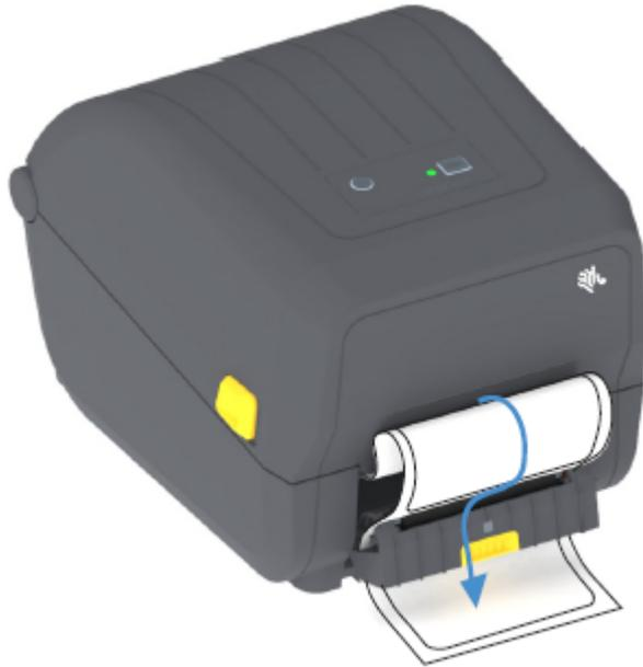
5. Cierre la tapa del dispensador mientras tira del extremo del recubrimiento de la etiqueta firmemente.
