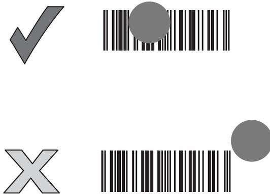
Le point de visée est plus petit lorsque le lecteur est proche du code-barres et plus grand lorsqu'il en est éloigné. Lisez les codes-barres comportant des barres ou des éléments de plus petite taille (en mm) près du lecteur et ceux dont les barres ou les éléments sont de plus grande taille (en mm) à plus grande distance.
