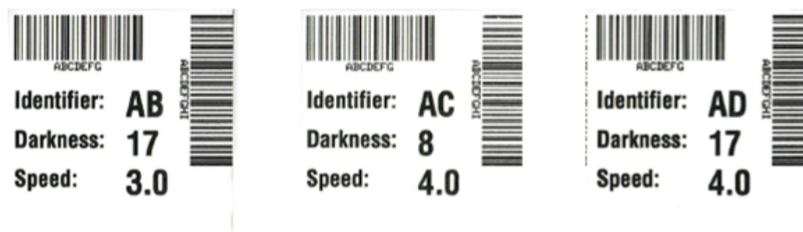
Figure 16 Impression test d'un échantillon de qualité d'impression
