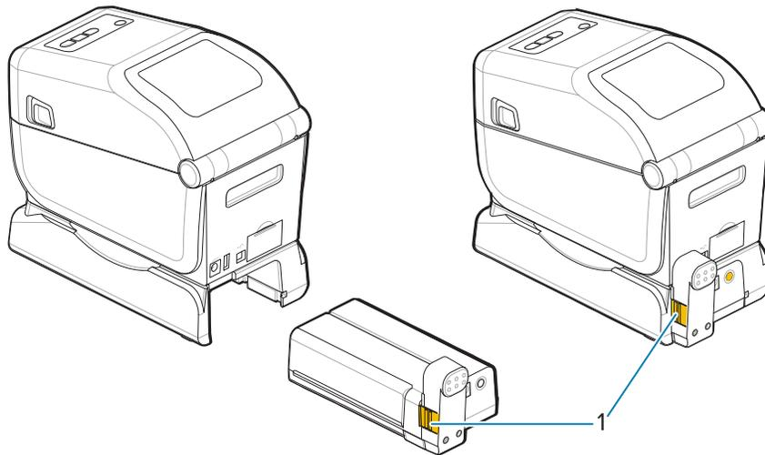
3. Collegare l'alimentatore della stampante alla batteria per riattivare la batteria dalla modalità di spegnimento e iniziare la carica iniziale.
