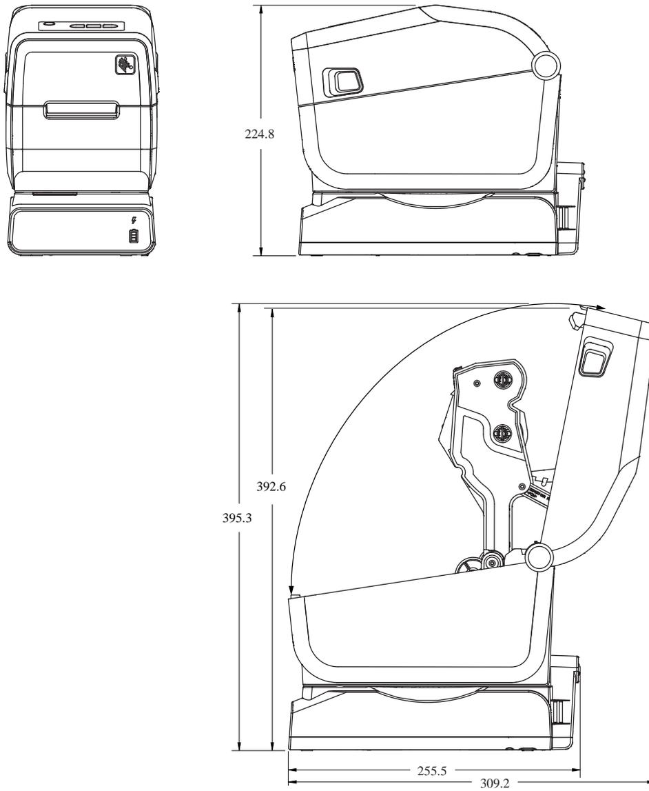
**Figura 21** Montaggio standard ZD411T (dimensioni in millimetri)
