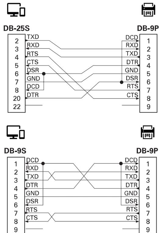
Interconnessione ai dispositivi DTE: la stampante è configurata come DTE (Data Terminal Equipment). Per collegare la stampante ad altri dispositivi DTE (come la porta seriale di un personal computer), utilizzare un cavo (crossover) null modem RS-232.
