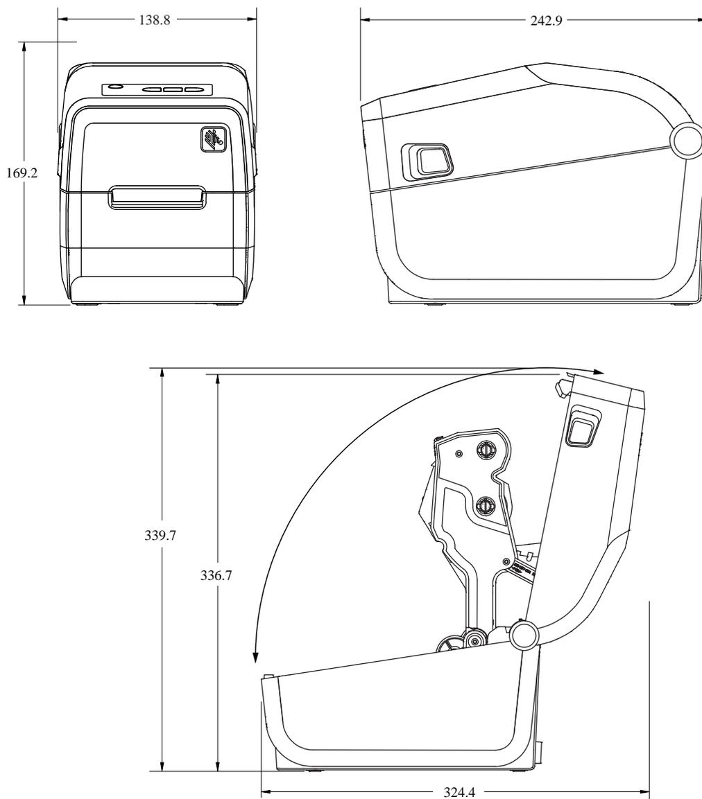
**Figura 18** Stampante con erogatore di etichette opzionale ZD411T (dimensioni in millimetri)
