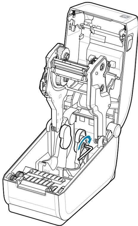
3. Fissare l'adattatore al supporto per rotolo utilizzando una vite.
