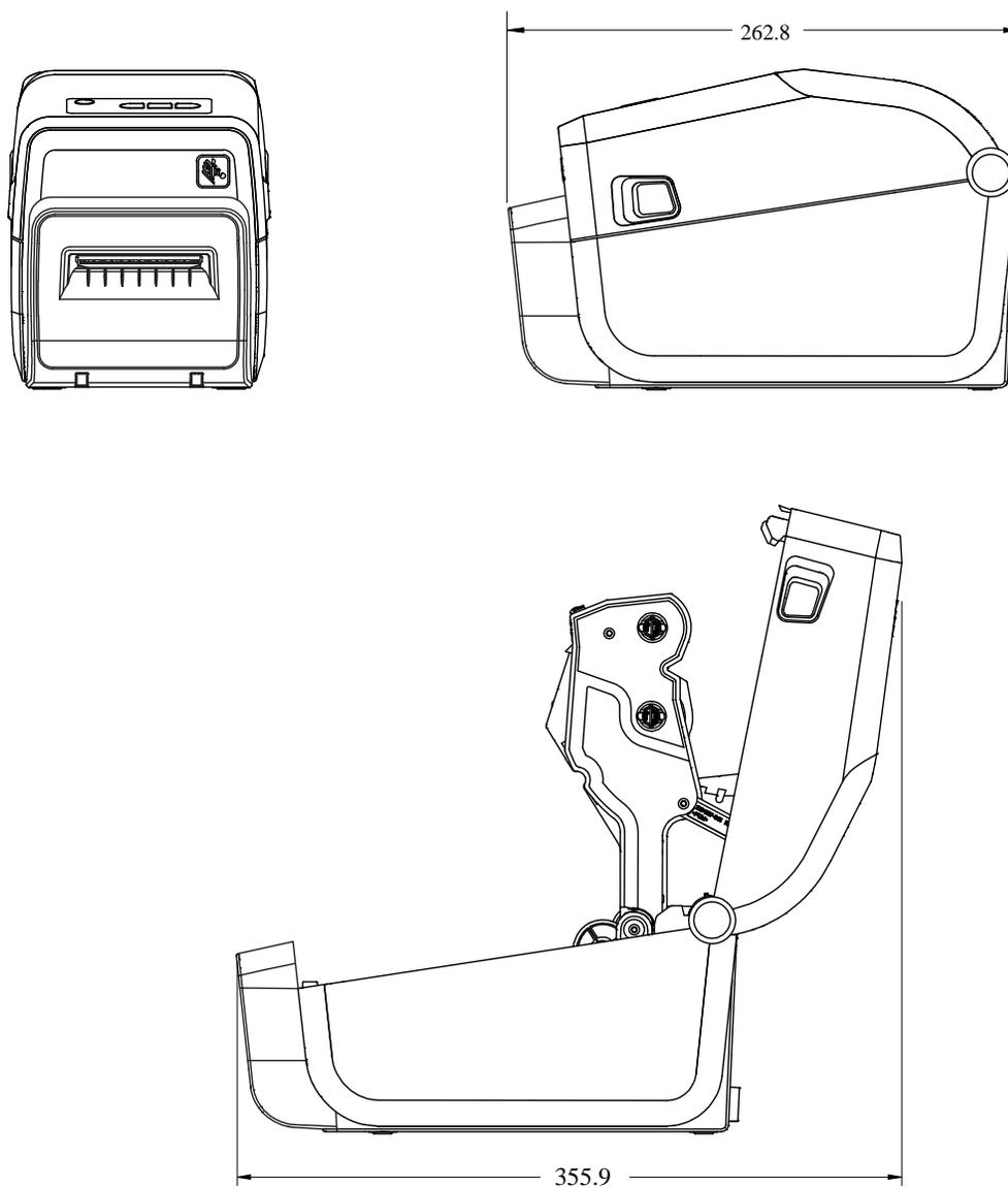
**Figura 20** Stampante aperta con base batteria opzionale collegata (dimensioni in millimetri) ZD411T
