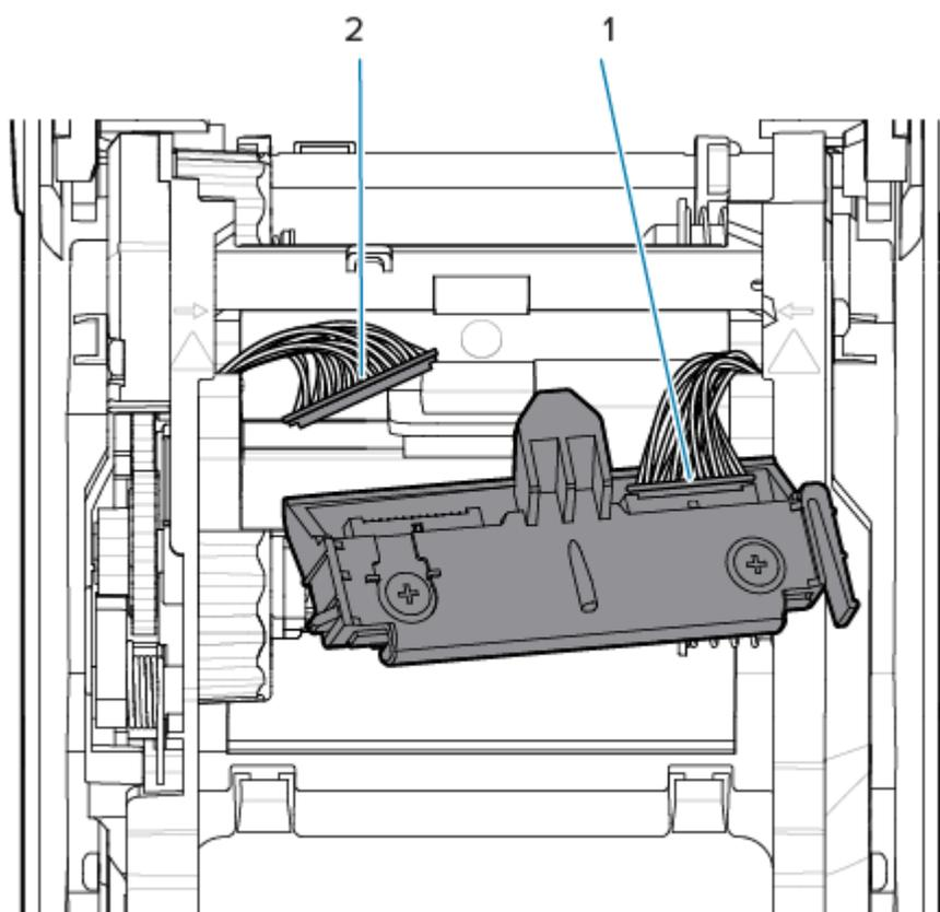
6. Inserire la linguetta centrale del gruppo testina di stampa nello slot centrale della staffa di montaggio della testina di stampa nel carrello del nastro.
