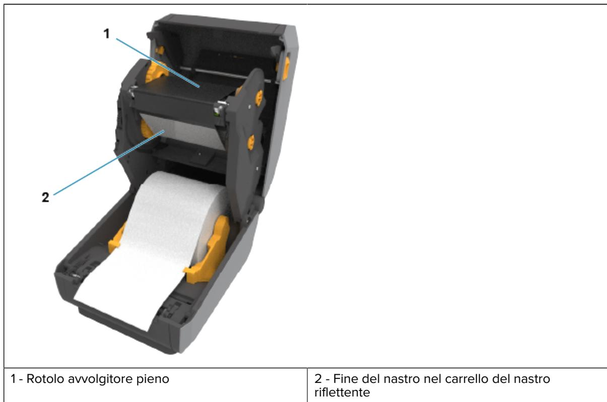
3. Rimuovere il rotolo di avvolgimento del nastro e smaltirlo correttamente. Tenere l'anima del nastro di alimentazione inferiore ora vuota rivolta verso la parte inferiore/posteriore del carrello del nastro.
