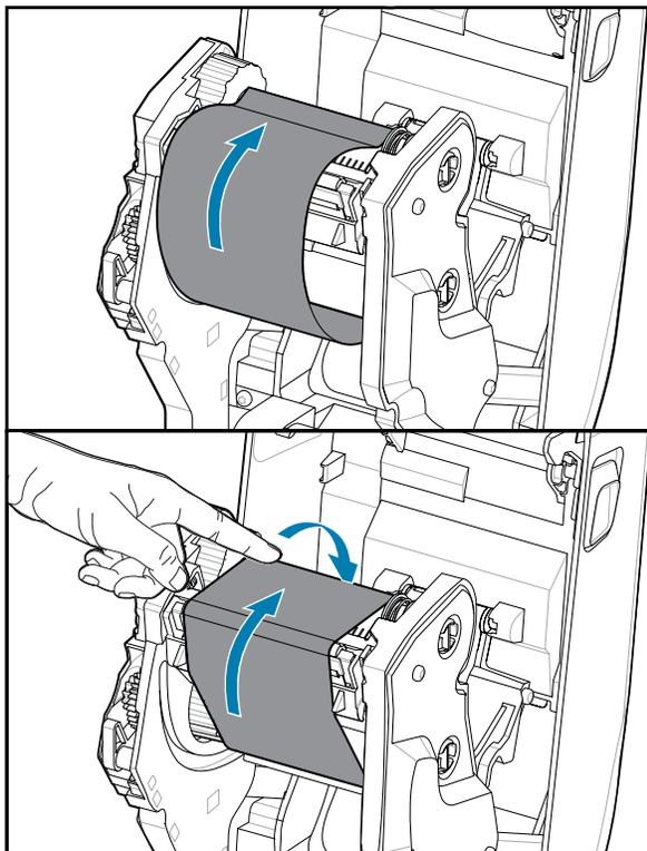
3. Fissare il nastro all'anima di avvolgimento. Utilizzare la striscia adesiva sui rotoli nuovi; in caso contrario, utilizzare una striscia sottile di nastro adesivo. Allineare il nastro in modo che venga portato direttamente sull'anima di avvolgimento.
