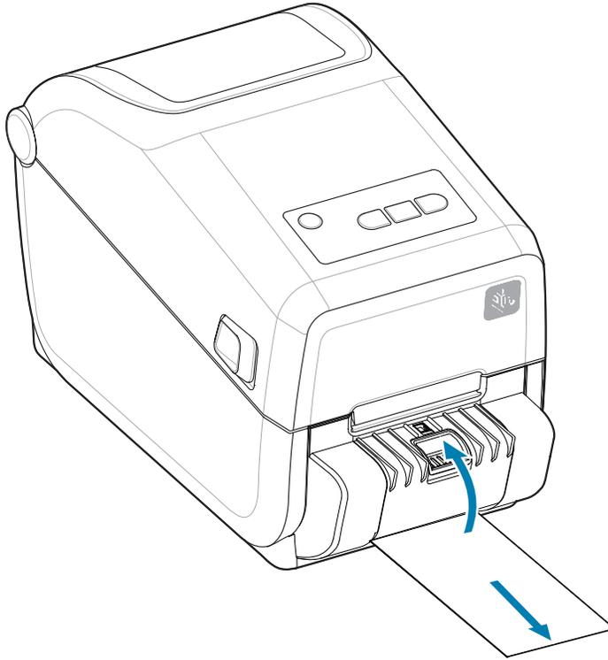
5. Premere e rilasciare il pulsante **ALIMENTAZIONE** (Avanzamento) una o più volte fino a quando non viene presentata un'etichetta per la rimozione.
