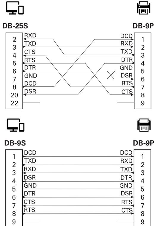
Interconnessione ai dispositivi DCE: se la stampante è collegata tramite l'interfaccia RS-232 all'apparecchiatura di comunicazione dati (Data Communication Equipment, DCE), ad esempio un modem, è necessario utilizzare un cavo di interfaccia RS-232 STANDARD (diretto).
