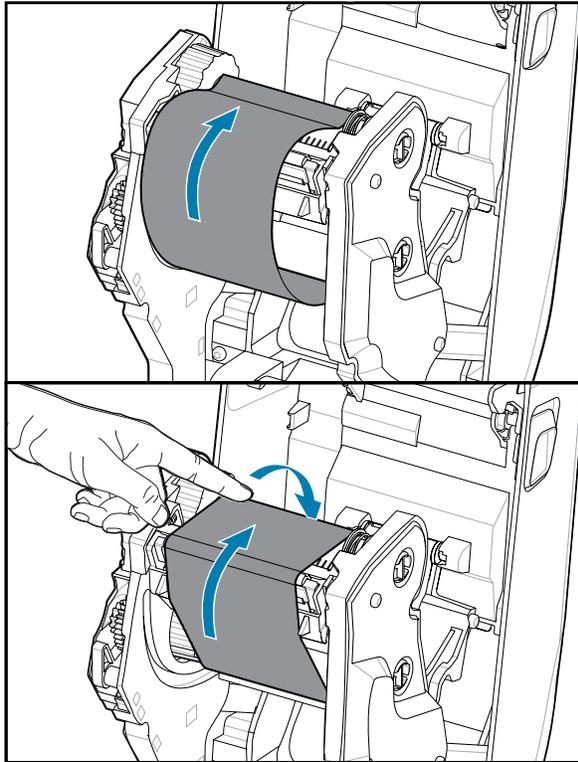
4. Ruotare la rotellina di avvolgimento del nastro con la parte superiore che si muove all'indietro per rimuovere l'allentamento del nastro. La rotazione della rotellina consente di completare l'allineamento della posizione del nastro di avvolgimento sul rullo del nastro di alimentazione. La parte iniziale del nastro deve essere completamente coperta dal nastro.
