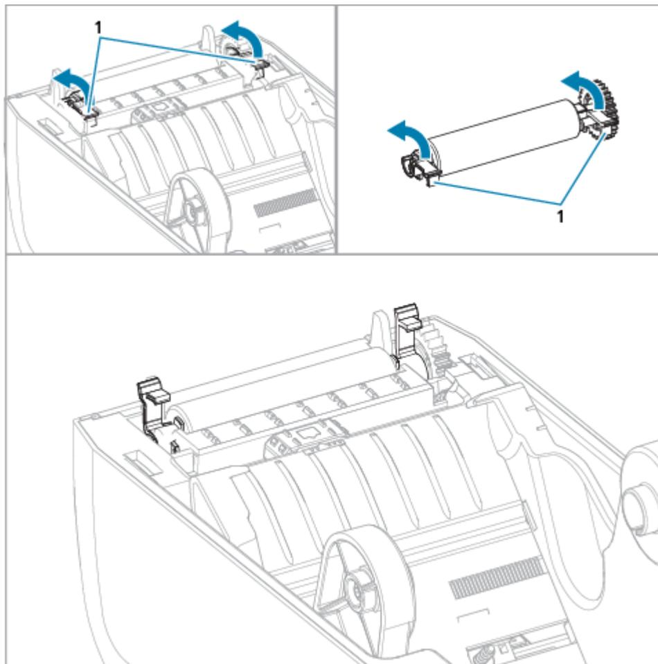
3. Sollevare il rullo dal telaio inferiore della stampante utilizzando i bracci di supporto (1).
