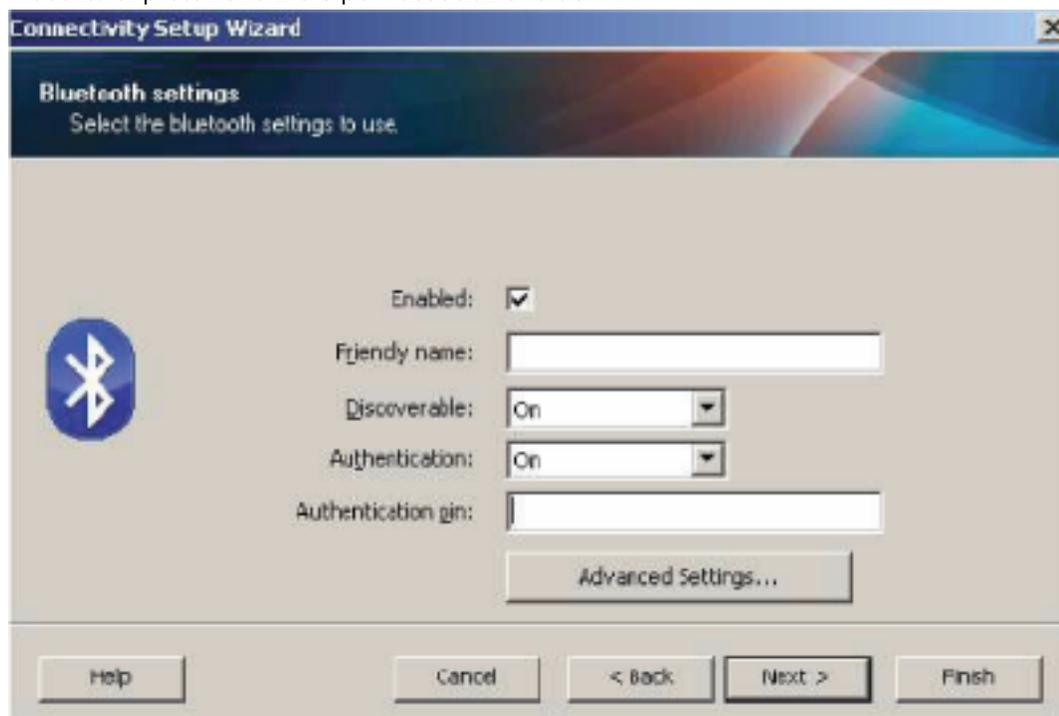
Se il dispositivo centrale utilizza BT v2.1 o versioni successive, questa impostazione non ha alcun effetto. BT v2.1 e versioni successive utilizzano SSP (Secure Simple Pairing) che non richiede l'uso di un PIN.
