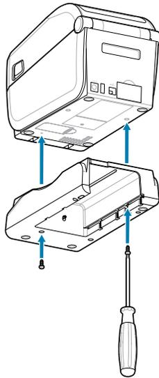
2. Utilizzare le due viti in dotazione per fissare la base della batteria alla stampante. Serrare le viti con la chiave esagonale T10.
