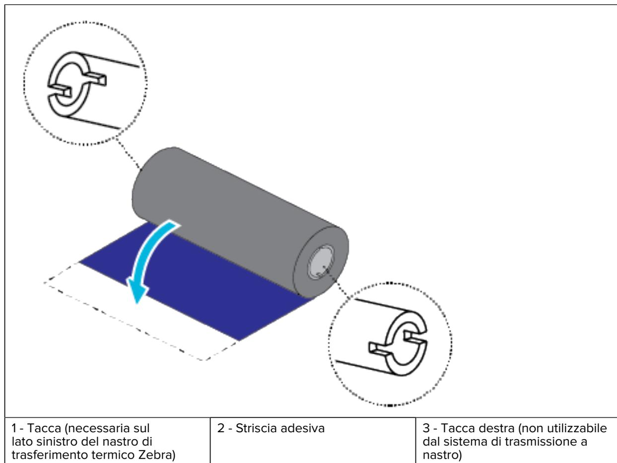
Verificare che il nastro e l'anima vuota del nastro siano dotati di tacche sul lato sinistro delle anime del nastro, come mostrato sopra.
