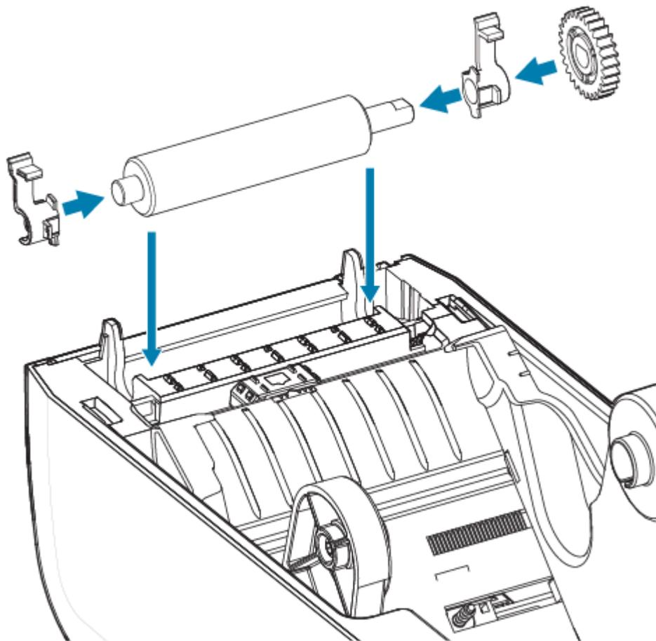
8. Allineare il rullo con l'ingranaggio a sinistra e abbassarla nel telaio inferiore della stampante.
