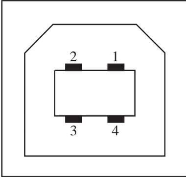
**Cablaggio - Connettore USB tipo B per il collegamento alla stampante o al dispositivo**
