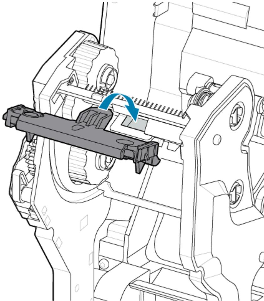
7. Inserire la linguetta sinistra del gruppo testina di stampa nello slot incassato sul lato sinistro del carrello del nastro.
