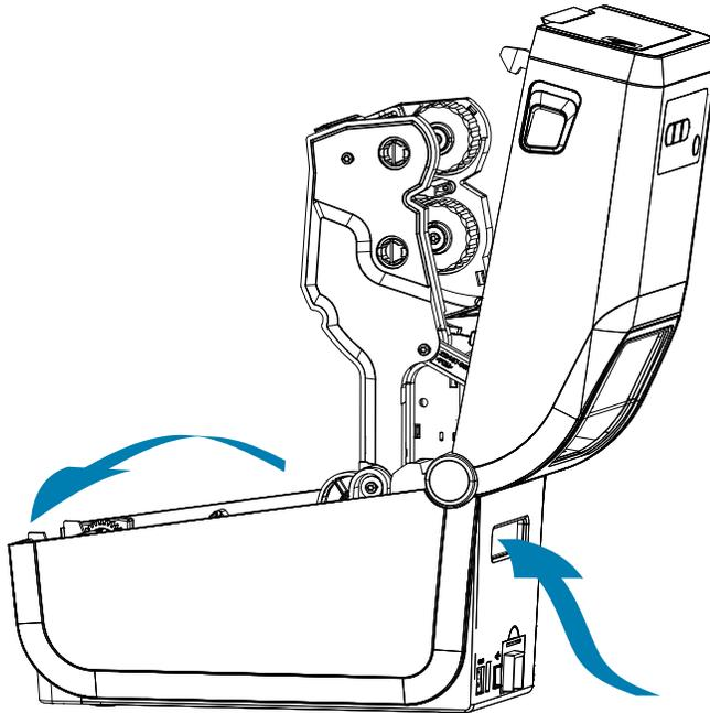
3. Regolare la posizione di arresto della guida del supporto con il blocco scorrevole grigio. Si trova all'esterno del supporto per rotolo di supporto sinistro. Utilizzare un pezzo del supporto a modulo continuo per impostare la larghezza della posizione di arresto. Spingere il blocco scorrevole grigio verso la parte posteriore della stampa per bloccarlo la posizione.
