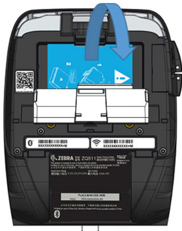
図 6 バッテリーの取り外し
