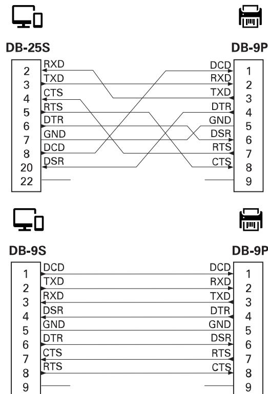
DCE 장치에 교차 연결 - 프린터가 RS-232 인터페이스를 통해 모뎀과 같은 DCE(데이터 통신 장비)에 연결된 경우, 표준 RS-232(관통형) 인터페이스 케이블을 사용해야 합니다.
