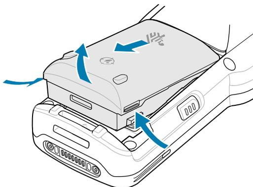
4. Para instalar a bateria, alinhe-a dentro do compartimento da bateria.
