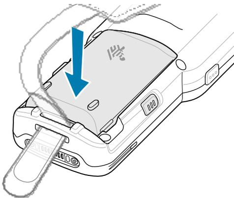
Em caso de troca a quente, o dispositivo é reiniciado automaticamente após a remoção e instalação da bateria. É necessário pressionar a tecla liga/desliga somente se o dispositivo tiver sido desligado ou deixado sem um conjunto de baterias por um longo período.
