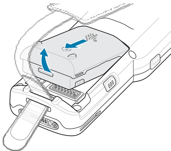
4. Para instalar a bateria, alinhe-a dentro do compartimento da bateria.
