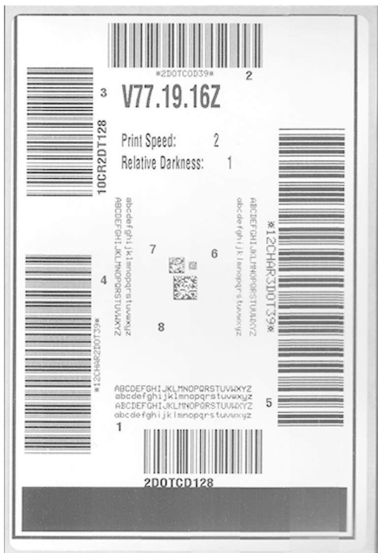
Figura 10 Imprimir teste de qualidade da amostra de impressão
