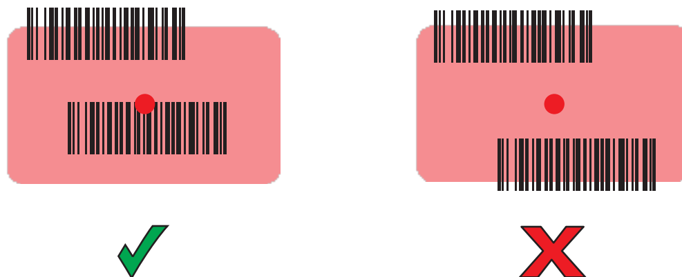
Bild 5 SE4720-siktmönster för plocklisteläget med flera streckkoder
