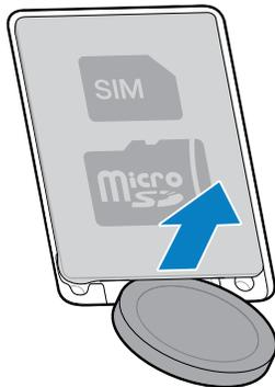
3. 將 SIM 卡座向右滑動以解除鎖定。
