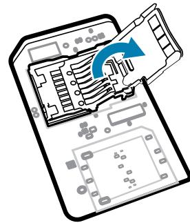
4. 將 microSD 卡插入卡座，並確定卡片滑入卡蓋兩側的固定片。
