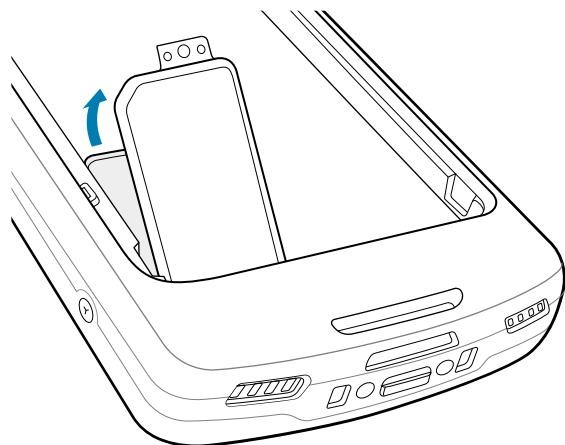
2. 將 SIM 卡座滑動到解除鎖定位置。
