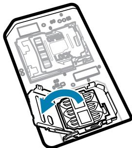
4. 將 SIM 卡以接點朝下的方式放入卡座中。
