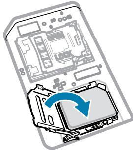
6. 將 SIM 卡座滑動到鎖定位置。
