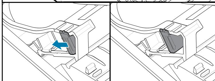
4. 讓耗材穿過印表機背面的插槽，並將耗材置於耗材導桿與捲筒支架之間。
