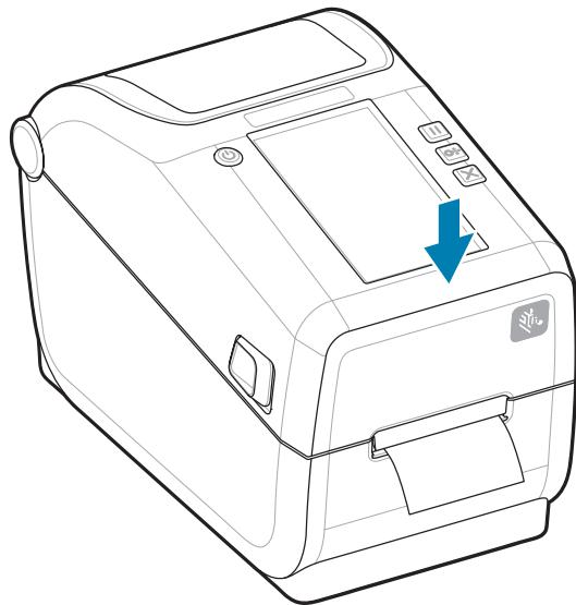
針對新耗材校準印表機。必須調整印表機感應器，才能感應標籤、裱紙及標籤之間的距離，進而正常運作。
