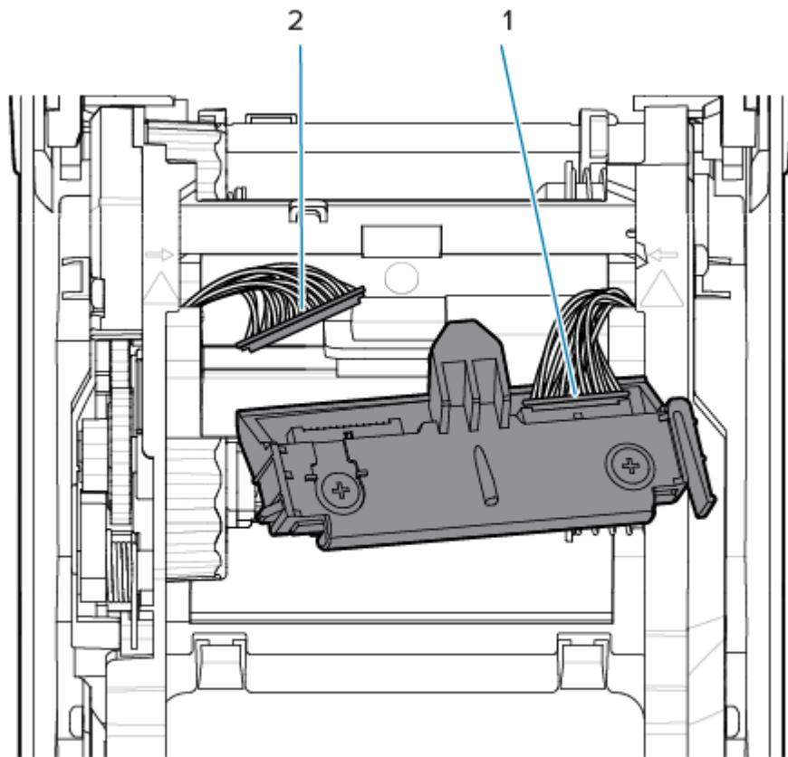
6. 將列印頭組件上的中間樁頭，插入碳帶匣中列印頭固定托架上的中央樁孔。
