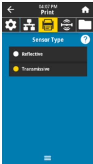
*Transmissive (###)* (透視耗材和裱紙) — 用於一般標籤和連續型耗材的間隙/膠片感應。此類耗材上沒有追蹤標記或凹口。
