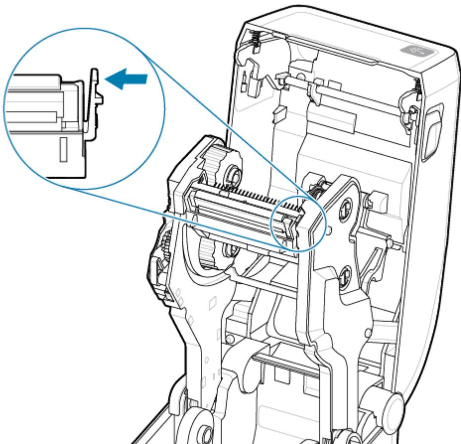
2. 將列印頭鬆開的右側從印表機中拉出。將其稍微向右拉，以清出列印頭的左側空間。將列印頭拉下並脫離碳帶匣，以便接觸列印頭連接的纜線。
