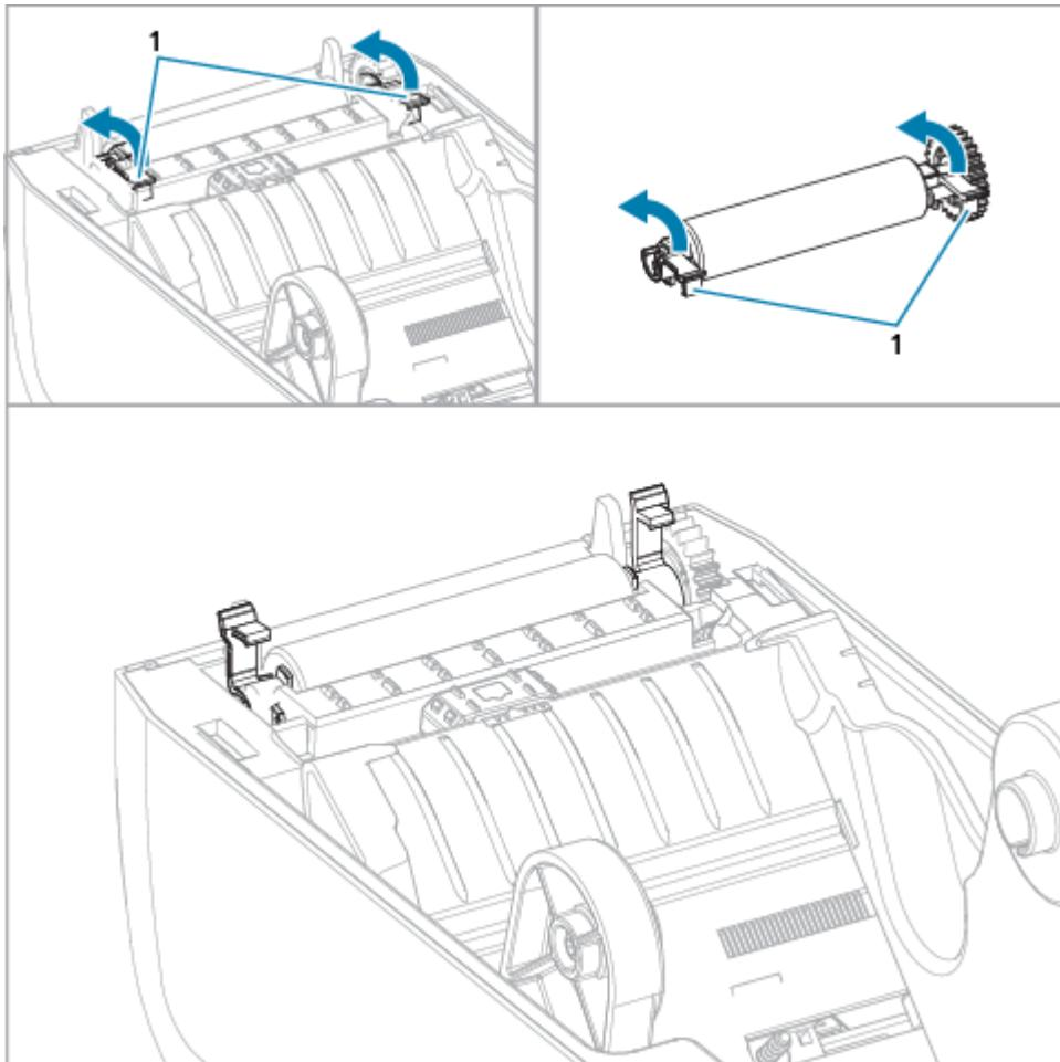
3. 使用軸承臂 (1) 將壓紙滾筒抬離印表機底架。
