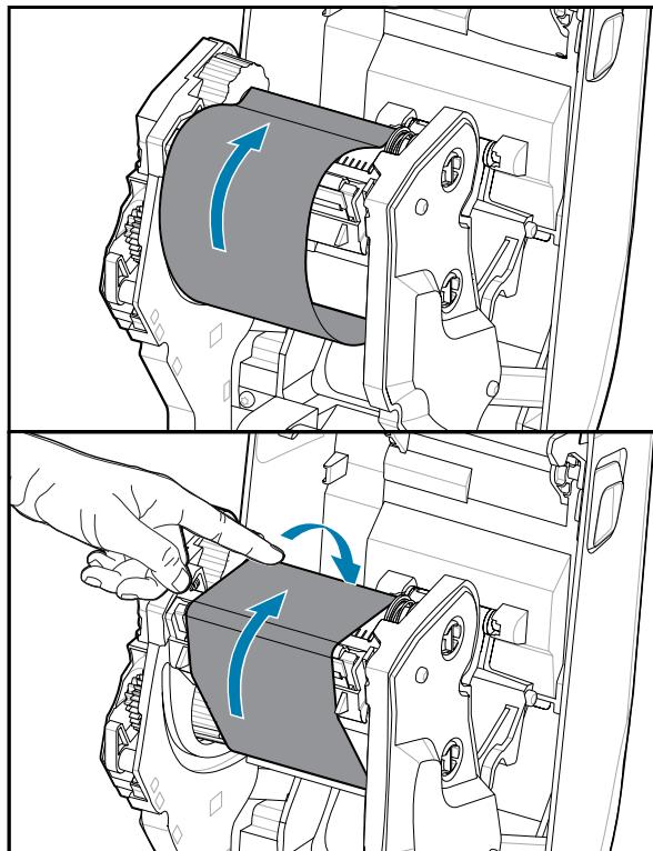
4. 將碳帶回收輪轂的頂端朝後方轉動，以去除碳帶鬆掉的部分。旋轉輪轂有助於將回收碳帶位置對齊至供應碳帶捲筒。碳帶應完全覆蓋碳帶頭。
