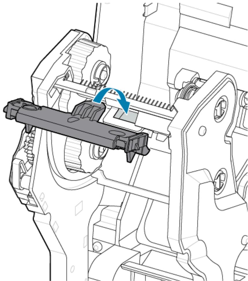
7. 將列印頭組件 (2) 的左側樁頭插入碳帶匣左側的凹槽 (1)。
