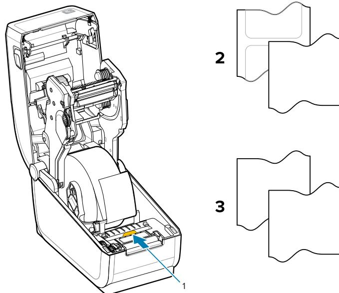
1 - 預設感應器位置 (透射式膠片/間隙感應)
