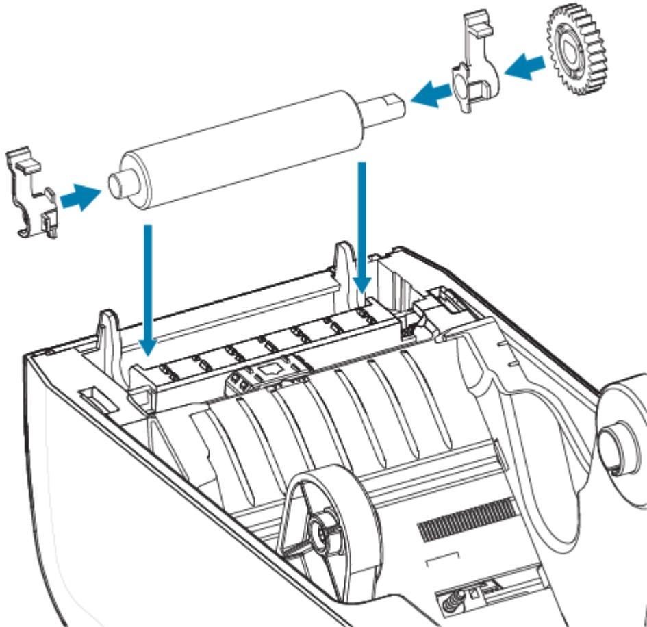
8. 將裝上齒輪的壓紙滾筒與左側對齊，並放入印表機的底架。
