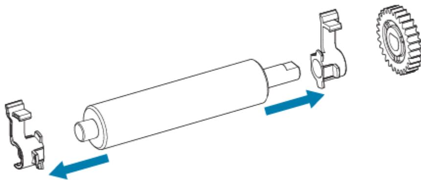
5. 僅清潔 — 使用以酒精沾濕的棉棒清潔壓紙滾筒。從中間向外清潔。重複此程序，直到所有滾筒表面都已清潔完畢為止。如果有嚴重的黏膠堆積或標籤卡紙，請使用新的棉棒重複上述步驟以去除殘留污染物，因為最初清潔可能會讓黏膠和油污層變薄，但無法完全清除。
