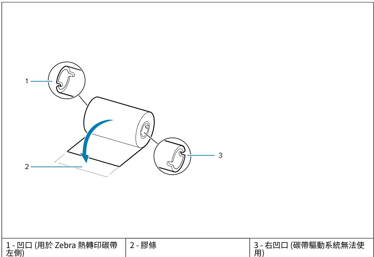
確認碳帶與空碳帶軸的碳帶軸左側有凹口，如上圖所示。
