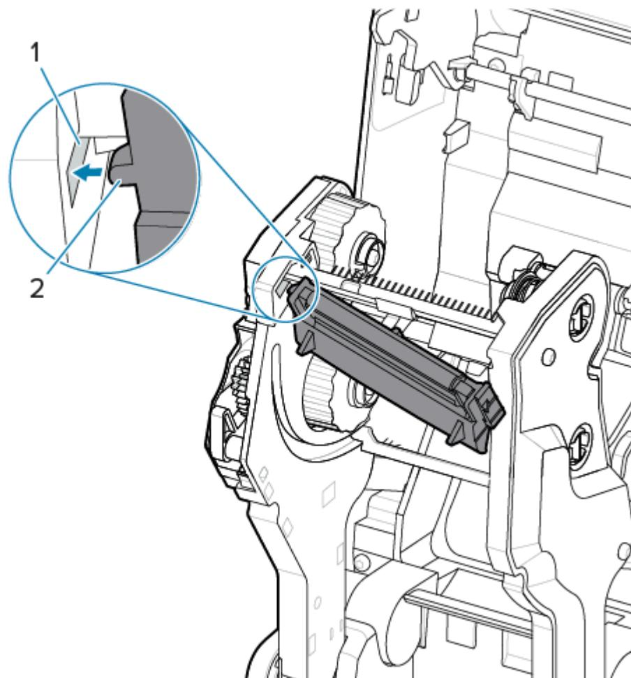
8. 將列印頭右側推入印表機，直到卡榫將列印頭右側鎖入印表機。
