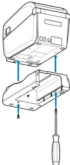
2. 使用隨附的兩顆螺絲，將電池底座裝到印表機上。使用 T10 內六角扳手鎖緊螺絲。
