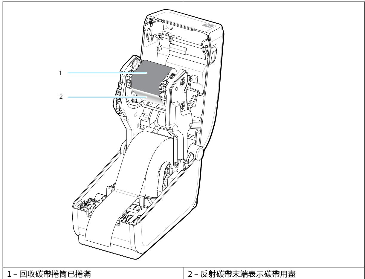
3. 取下用過的回收碳帶捲筒，並妥善棄置。請讓已清空的下方「供應碳帶」軸朝向碳帶匣的底部/背面放置。
