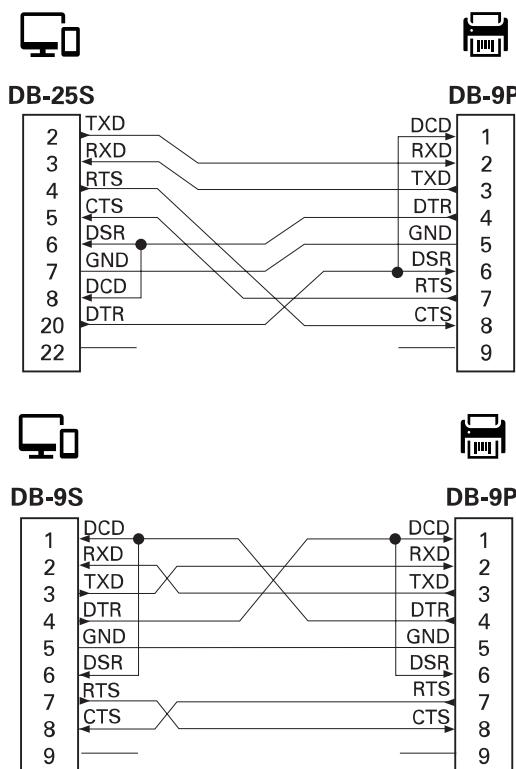
與 DTE 裝置互連 - 印表機已設為資料終端設備 (DTE)。若要將印表機連接至其他 DTE 裝置 (例如個人電腦的序列埠)，請使用 RS-232 虛擬數據機 (跳接) 繩線。
