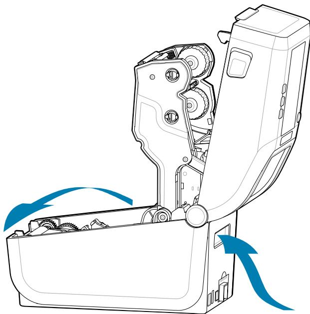
3. 使用灰色滑鎖調整耗材導桿的停止位置。它位於左側紙張捲軸支架的外側。使用一張摺疊式耗材設定停止位置寬度 將灰色滑鎖朝列印的背面推，以鎖定其位置。
