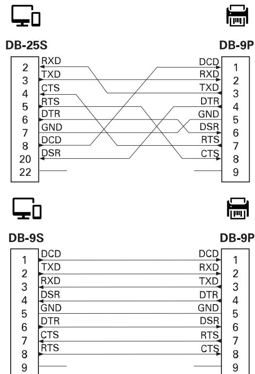
與 DCE 裝置互連 - 當印表機透過其 RS-232 介面連接至數據機等數據通訊設備 (DCE) 時，必須使用標準 RS-232 (直通式) 介面纜線。
