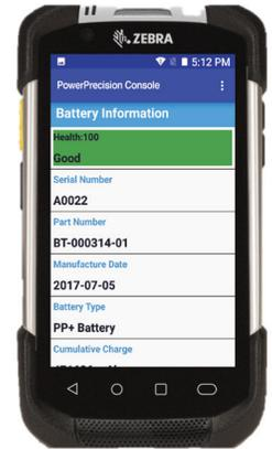
PowerPrecision Console proporciona toda la información relevante sobre las baterías instaladas que usted necesita saber, para identificar y retirar de su flota las baterías en mal estado. La información se encuentra disponible en el dispositivo móvil y en el panel al que se puede acceder desde prácticamente cualquier dispositivo – computadora desktop o portátil, tableta, etc.
