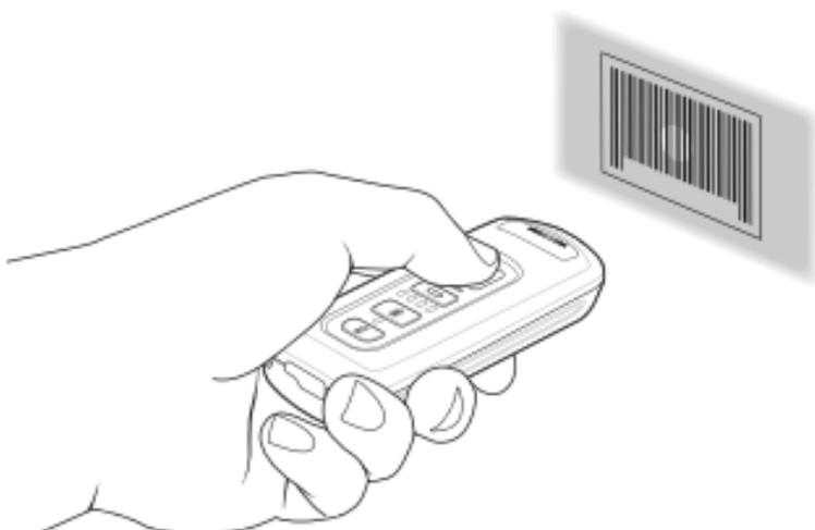
3. Stellen Sie sicher, dass die Punkterfassung mittig über den Barcode gerichtet ist.
