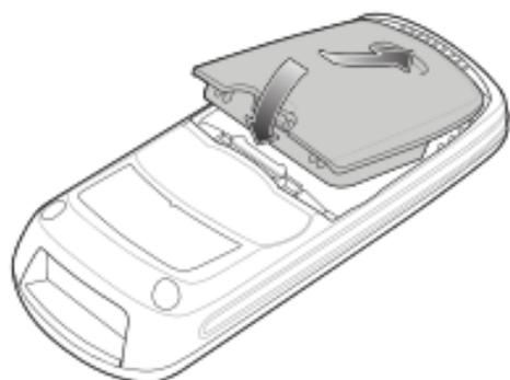
2. 将电池按入电池舱中，直到电池释放闩锁销卡入到位。
