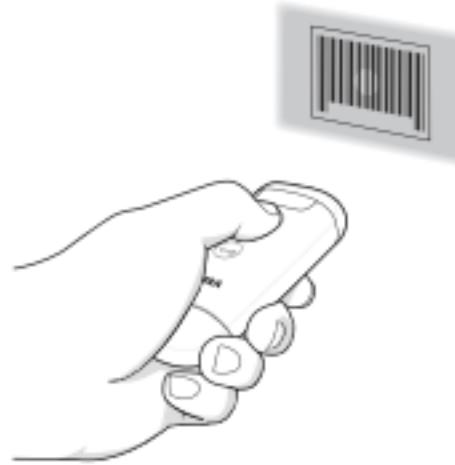
3. 确保瞄准点在条码的中心。
