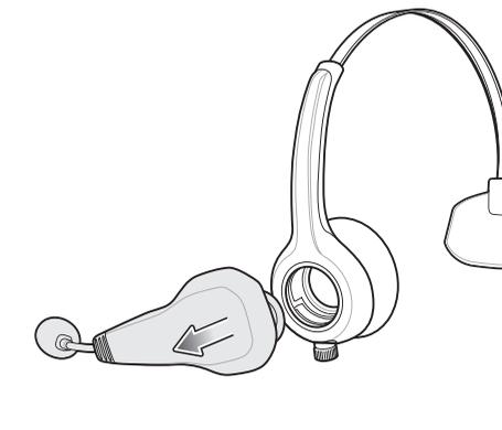
Zerlegen Sie den Kopfhörer, um den Kopfbügel zu ersetzen.
