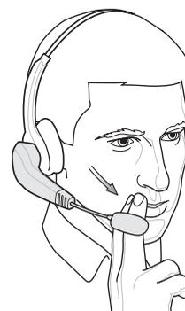
Установите микрофон на расстоянии двух пальцев от уголка рта, чтобы он был отклонен немного в сторону.
