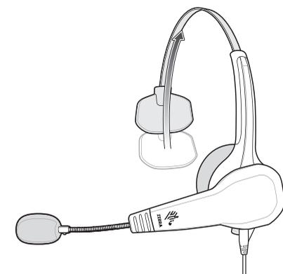
Головная дужка наушников может быть отрегулирована для более плотной посадки на голове. Положение фиксируется со щелчком. При регулировке головной дужки:
