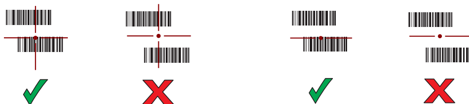
Figura 6 Modo de lista de selección con varios códigos de barras en un patrón de enfoque: rango estándar y ampliado
