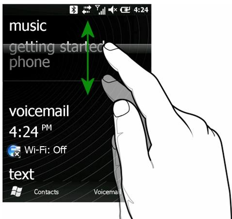
**Figura C-3** *Spostamento della barra di stato delle informazioni*
