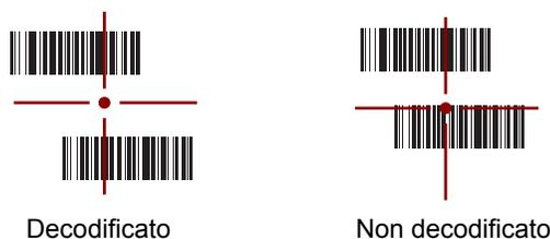
**Figura 2-31** Modalità lista di prelievo con codici a barre multipli nel reticolo di puntamento
