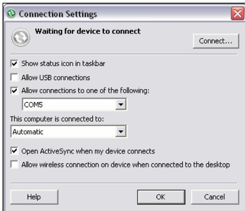
圖 5-24 個人電腦上的 ActiveSync 連線設定視窗
