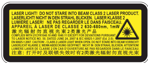
Рис. 3.1 Этикетка с инструкциями по технике безопасности при работе с лазером
