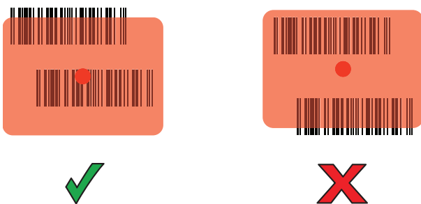
图 19 带有多个条码的多条码模式
