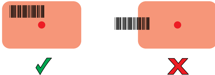
图 9 条码拣读模式，并且瞄准图案中有多个条码
