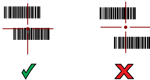
图 18 RS6000 Pick List 模式，并且瞄准图案中有多个条码
