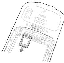
8. 将 SIM 卡插入或更换到 SD/SIM 卡托盘中。
