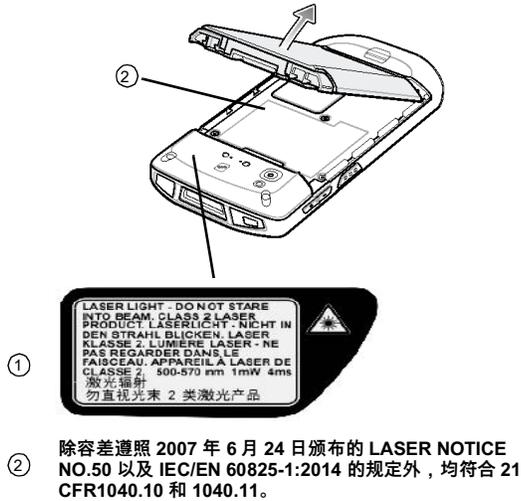
1. 激光 - 切勿直视 2 级光束激光产品。500-570nm，1mW 4ms
