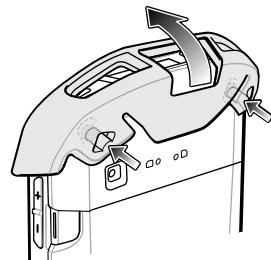
4. ハンドストラップのタブの先端をデバイスのスロットに挿入します。
