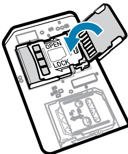
6. 将 microSD 卡架盖滑动至“锁定”位置。
