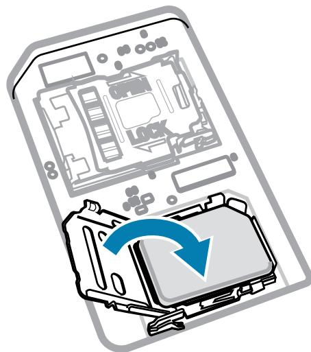
6. 将 SIM 卡架盖滑动至“锁定”位置。
