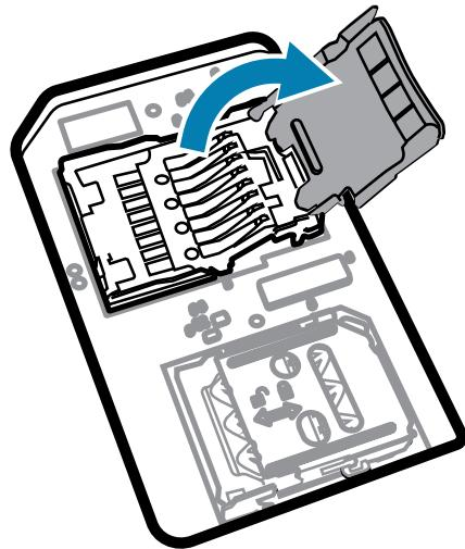
4. 将 microSD 卡插入卡架，确保卡滑入卡架盖两侧的卡舌。
