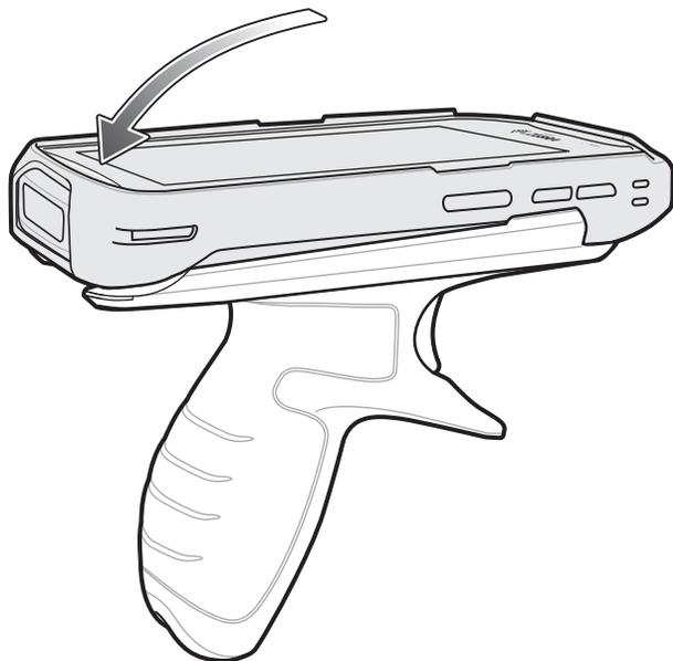
**Figura 7-42** Recostar el dispositivo sobre el mango con gatillo
