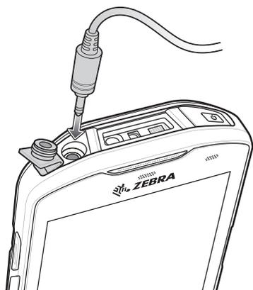
**Figura 7-26** Instalación del adaptador de audio
