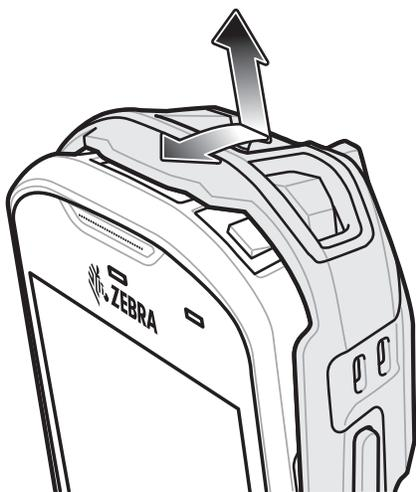
**Figura 7-38** Deslizar la funda por sobre el dispositivo
