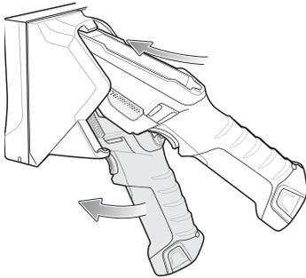
2. Der Akku des TC8300 wird automatisch aufgeladen. Das Aufladen des Akkus des TC8300 dauert ungefähr vier Stunden.
