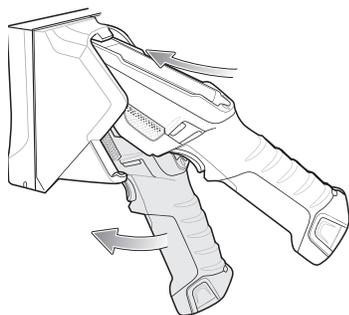
2. Il TC8300 inizia a ricaricarsi automaticamente. Il TC8300 impiega circa quattro ore per ricaricarsi.
