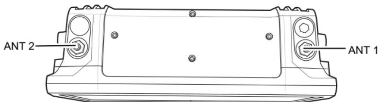
ANT 1: antena principal externa del conector de polaridad inversa (WLAN + BT)
