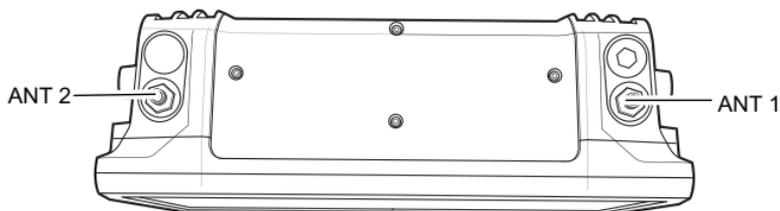
ANT 1 - Entrada de Polaridade Reversa (WLAN + BT) antena principal externa
