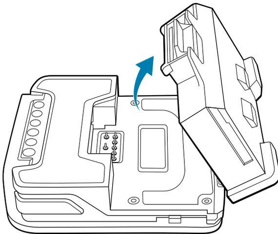
5. Richten Sie den Akku so aus, dass die Unterseite des Akkus in die Verriegelungsschlitze (1) einrastet.
