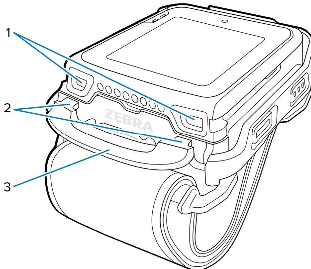
Die Verriegelungslaschen (2) werden aus den Verriegelungsschlitz (1) entfernt.
