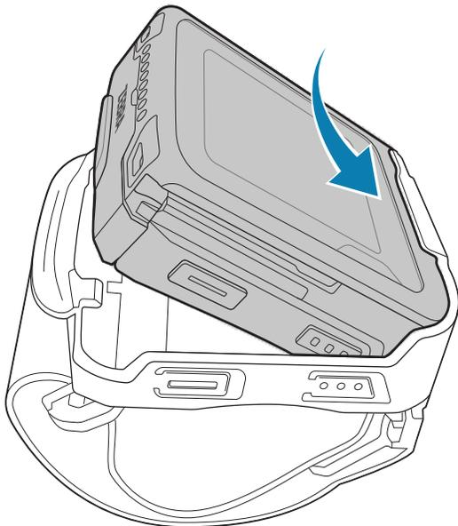
3. Drücken Sie gleichzeitig die Freigabelasche der Handgelenkhalterung (3) und das Gerät nach unten, bis die Verriegelungslaschen (2) in die Verriegelungsschlitze (1) gleiten.
