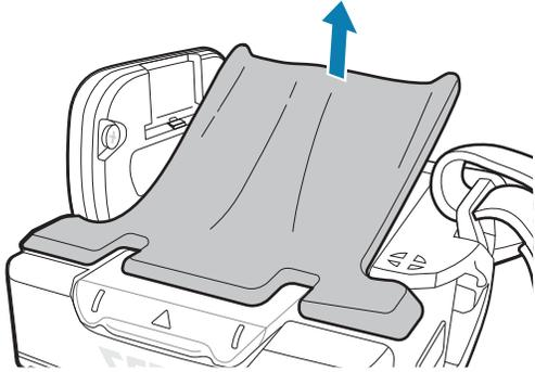
**2.** Befolgen Sie die Anweisungen, die auf der Rückseite des Geräts zu finden sind, um die Auslösereinheit zu entfernen.
