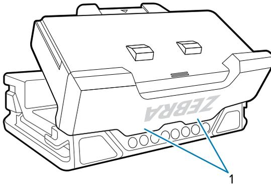
6. Drücken Sie den Akku nach unten in das Akkufach, bis die Akkuentriegelungen hörbar einrasten.
