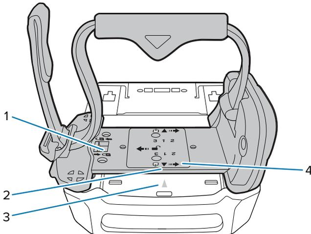
5. Schieben Sie die Auslöseereinheit in Richtung der Verriegelung (4).
