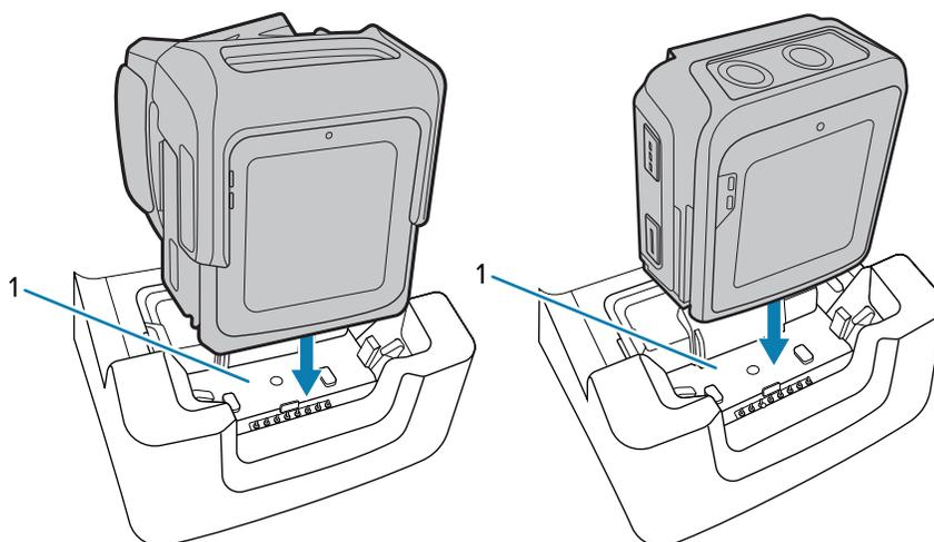
Das Gerät schaltet sich ein und beginnt mit dem Ladevorgang. Die Benachrichtigungs-LED auf dem Touch-Panel leuchtet während des Ladens orange. Wenn der Akku vollständig aufgeladen ist, leuchtet die LED grün.
