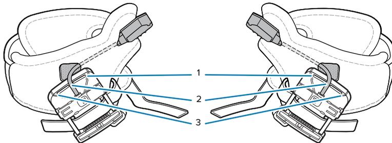
Die Handrückenhalterung verfügt über drei Schlitze für die Positionierung des Auslöserkabels. Ziehen Sie das Auslöserkabel entsprechend der Größe der Hand des Benutzers durch einen der Schlitze:
