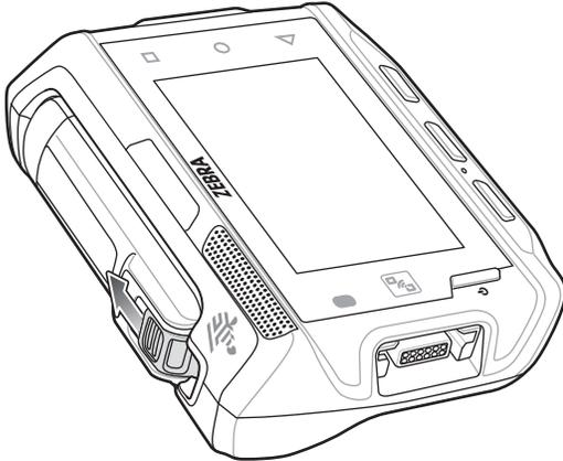
**Figura 6** Tire del pestillo de liberación hacia atrás en la batería extendida
