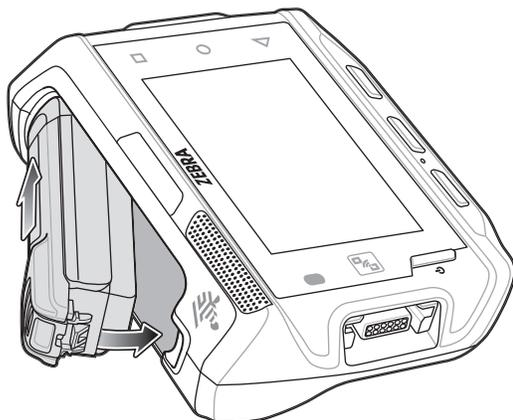
**Figura 4** Installazione della batteria estesa
