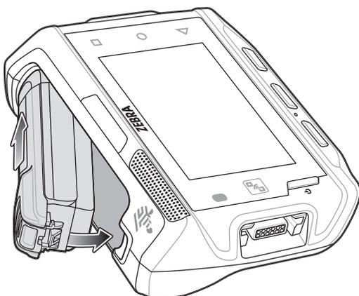
**Figura 10** Installazione della batteria estesa
