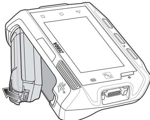
**Figura 8** Remoção da bateria estendida
