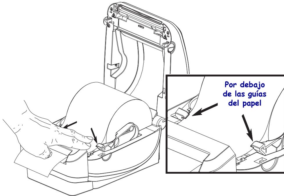
6. Cierre la impresora. Presione hacia abajo hasta que la cubierta calce en posición.
