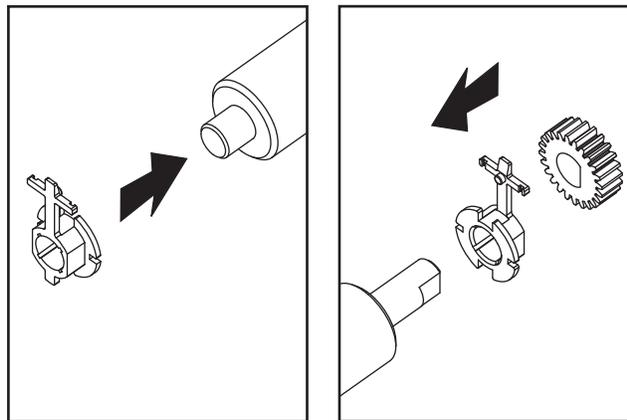
7. Alinee el rodillo portapapeles con el engranaje a la izquierda y bájelo dentro del bastidor inferior de la impresora.
