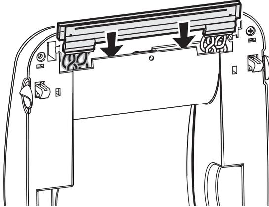
Limpie el cabezal de impresión como se describe en [Limpieza del cabezal de impresión en la página 77](#).
