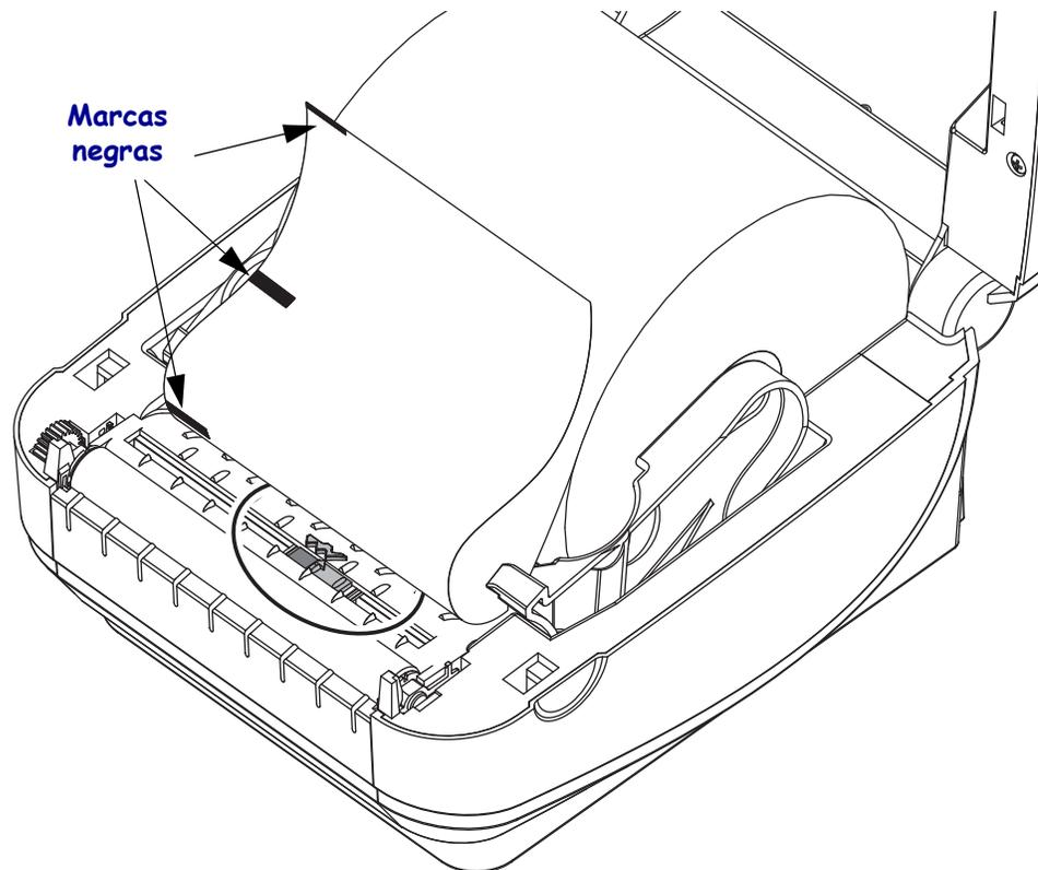
2. Deslice el sensor móvil desde la posición predeterminada del centro para que se alinee con las marcas negras. La flecha sobre el sensor móvil debe alinearse con el borde derecho de la marca negra. Esto es válido para marcas o muescas ubicadas en cualquier lado del papel (se muestra el lado izquierdo).
