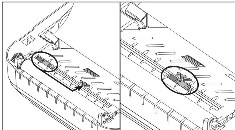
4. Tire del papel de manera que se extienda fuera del frente de la impresora. Verifique que el rollo gire libremente. El rollo no debe apoyarse en la parte inferior del compartimiento del papel. Verifique que la superficie de impresión del papel esté hacia arriba.
