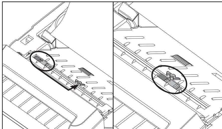
4. Haga pasar el papel a través de la ranura interior del cortador de modo que se extienda fuera del frente de la impresora. Verifique que el rollo gire libremente. El rollo no debe apoyarse en la parte inferior del compartimiento del papel. Verifique que la superficie de impresión del papel esté hacia arriba.
