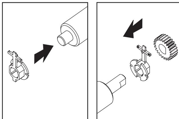
7. Allineare il rullo all'ingranaggio sulla sinistra e inserirlo nel telaio inferiore della stampante.
