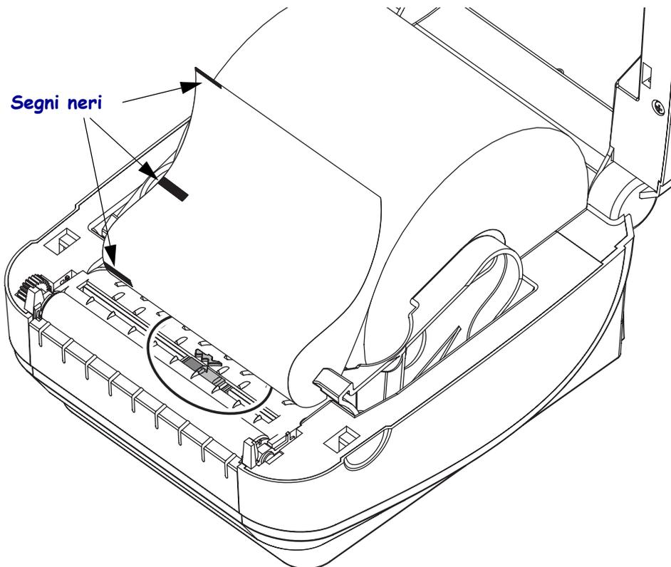
2. Far scorrere il sensore mobile dalla posizione predefinita al centro per allinearlo con i segni neri. Allineare la freccia sul sensore mobile al margine destro del segno nero. Questa operazione è valida per segni o tacche su uno dei lati del supporto (lato sinistro in figura).
