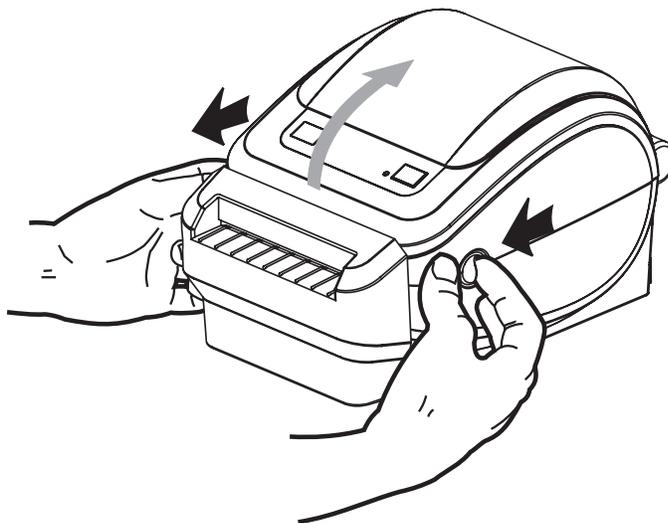
2. Aprire i supporti rotolo. Aprire le guide dei supporti con la mano libera, inserire il rotolo sui supporti e rilasciare le guide. Orientare il rotolo di supporti in modo che la superficie stampabile sia rivolta verso l'alto al passaggio sopra il rullo.
