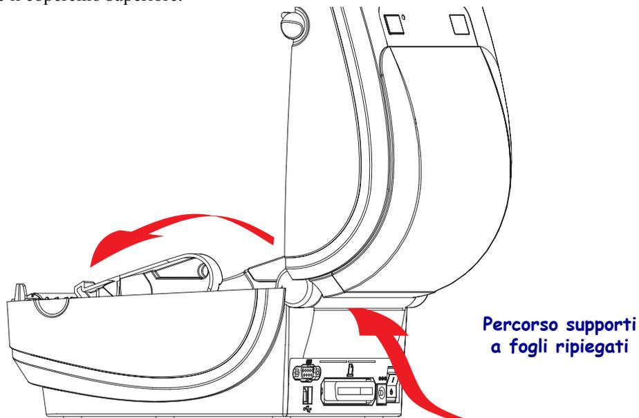
2. Regolare la posizione di arresto delle guide dei supporti con la rotella verde. Utilizzare un pezzo del supporto ripiegato per impostare la posizione di arresto. Ruotare la rotella verso l'esterno per allargare le guide. Ruotare la rotella verso l'interno per stringere le guide dei supporti.
