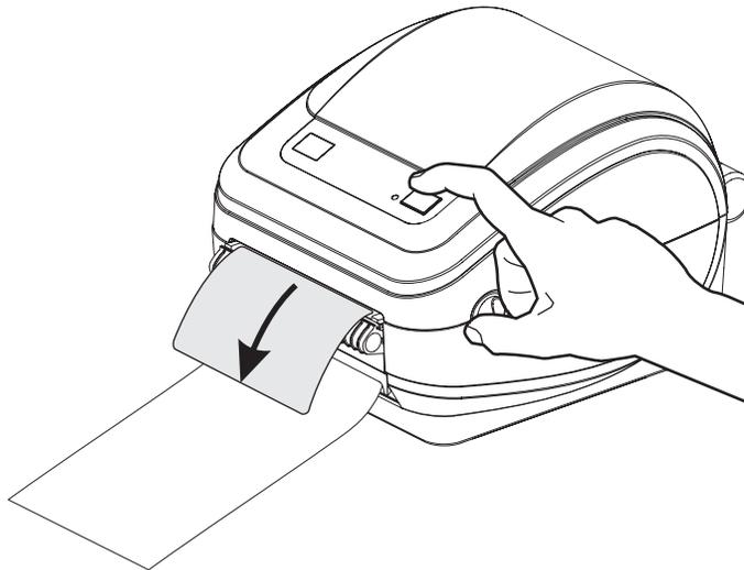
6. Nel corso dell'operazione di stampa, la stampante staccherà il supporto e presenterà un'etichetta singola. Prendere l'etichetta dalla stampante, in modo che possa passare alla stampa dell'etichetta successiva. Nota: se il sensore di prelievo dell'etichetta non viene attivato tramite comandi software, verranno stampate più etichette senza pellicola di supporto.
