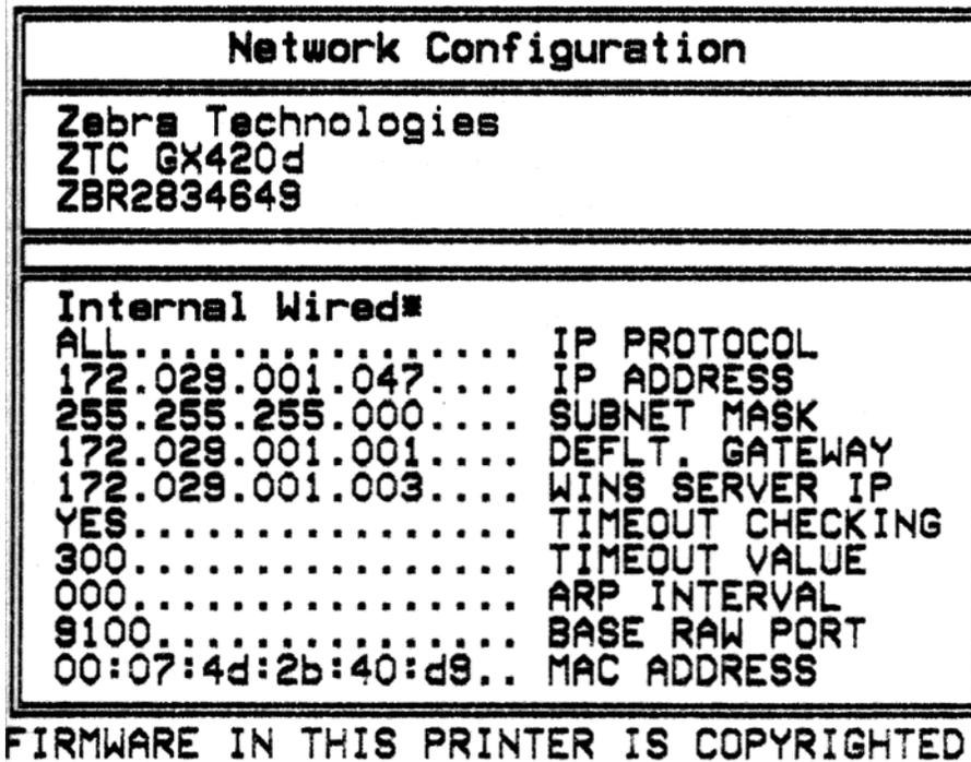
Normalmente l'etichetta di stato della configurazione contiene nella parte inferiore alcune delle impostazioni di rete della stampante, quali ad esempio l'indirizzo IP.
