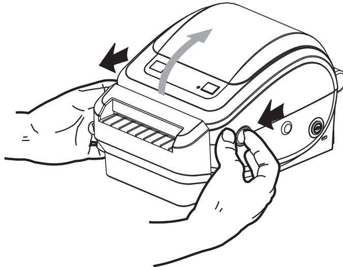
2. Abra los soportes del rollo de papel. Abra las guías del papel con la mano libre, coloque el rollo de papel en los soportes del rollo y libere las guías. Oriente el rollo de papel de modo que su superficie de impresión esté hacia arriba y pase por encima del rodillo portapapeles (de arrastre).
