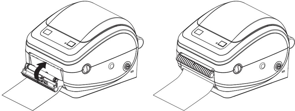
5. Cargue una etiqueta y quítela de una a tres veces para eliminar la holgura del papel protector de la etiqueta (rodillo de rebobinado). Consulte [Preinstalar los controladores Windows® de la impresora en la página 16](#) para cargar etiquetas utilizando la Zebra Setup Utility Zebra Setup Utility (Utilidades de configuración de Zebra) o el Windows Driver (Controlador para Windows).
