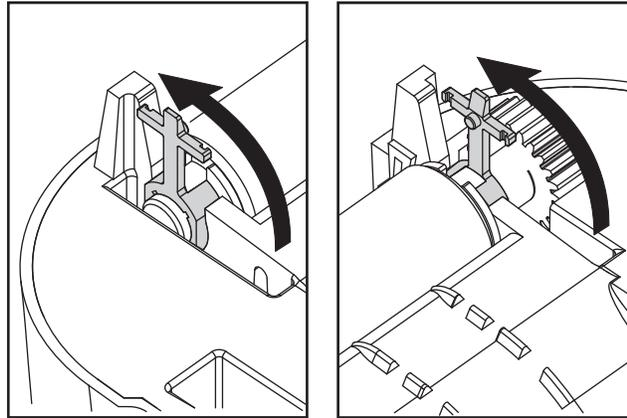
3. Levante el rodillo portapapeles fuera del bastidor inferior de la impresora.
