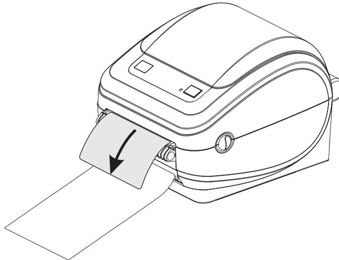
6. Durante el trabajo de impresión, la impresora despegará el papel protector y presentará una etiqueta sola. Extraiga la etiqueta de la impresora para que pueda imprimir la siguiente etiqueta. Nota: Si no activó el sensor de etiqueta tomada para detectar la extracción de la etiqueta distribuida (despegada) con los comandos de software, la impresora eyectará y apilará etiquetas despegadas.
