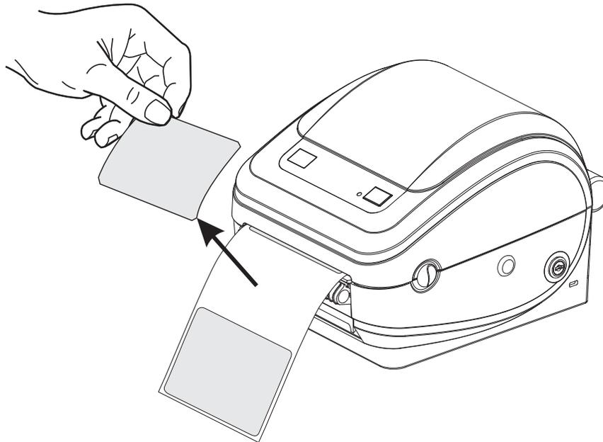
2. Levante el papel protector por encima de la parte superior de la impresora y abra la puerta del distribuidor.
