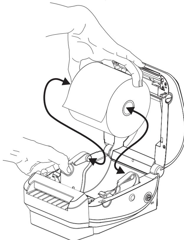
3. Haga pasar el papel a través de la ranura interior del cortador de modo que se extienda fuera del frente de la impresora. Verifique que el rollo gire libremente. El rollo no debe apoyarse en la parte inferior del compartimiento del papel. Verifique que la superficie de impresión del papel esté hacia arriba.
