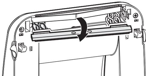
3. Desenchufe de sus conectores ambos haces de conductores del cabezal de impresión.
