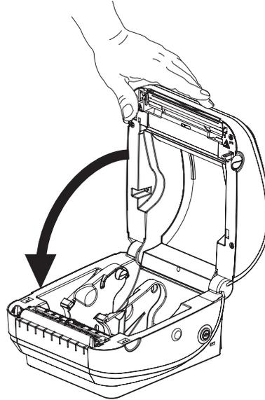
2. Presione hacia abajo hasta que la cubierta calce en posición.
