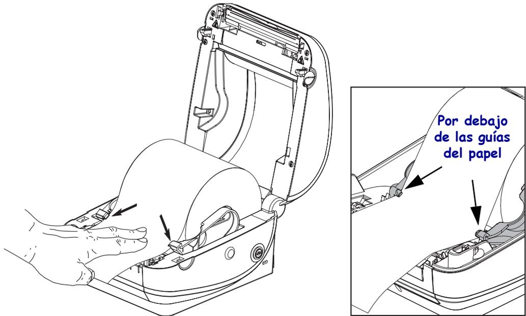
4. Cierre la impresora. Presione hacia abajo hasta que la cubierta calce en posición.
