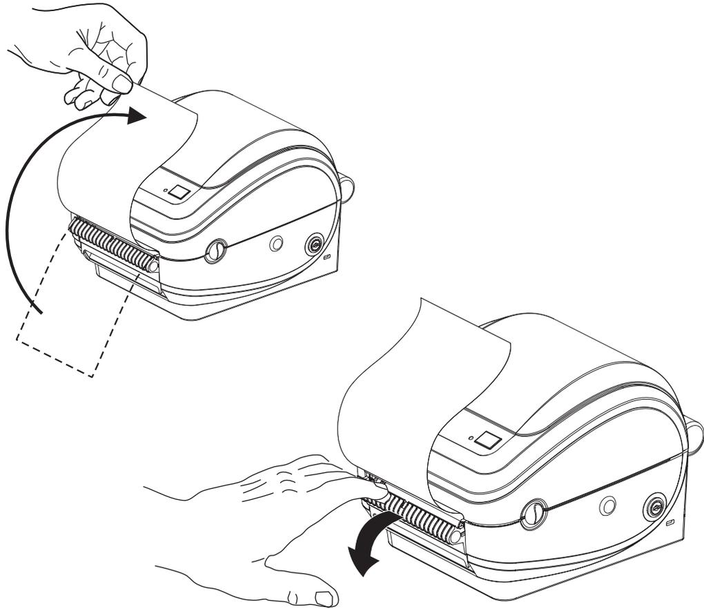
3. Inserte el papel protector de la etiqueta entre la puerta del distribuidor y el cuerpo de la impresora.
