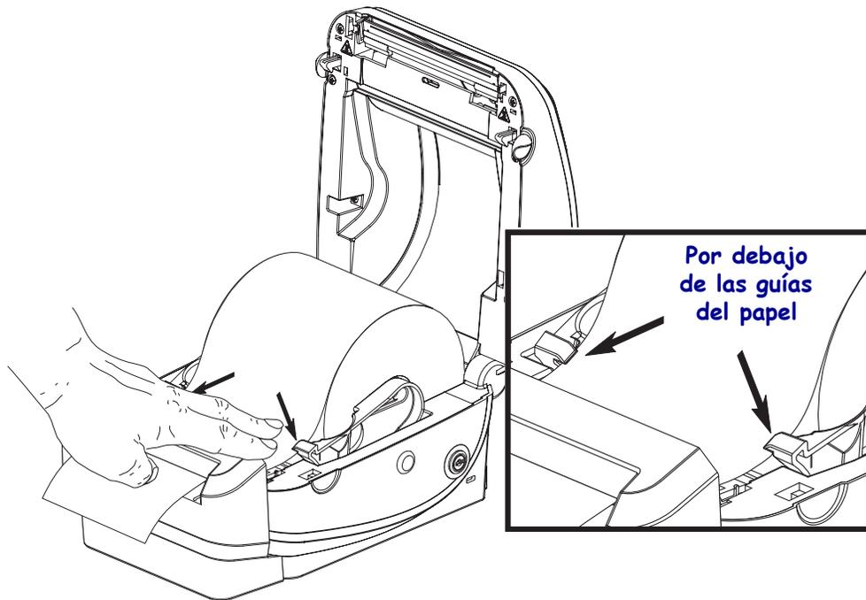
5. Cierre la impresora. Presione hacia abajo hasta que la cubierta calce en posición.
