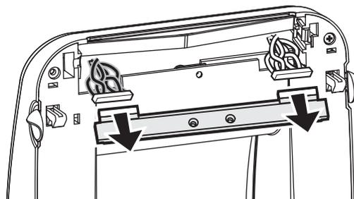
1. Alinee el cabezal de impresión para enchufar los conectores izquierdo y derecho en los haces de conductores.
