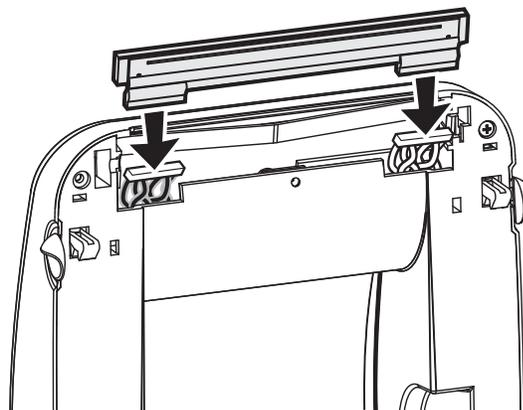
2. Deslice el cabezal de impresión hasta el lado izquierdo y empújelo hacia la traba del lado derecho.
