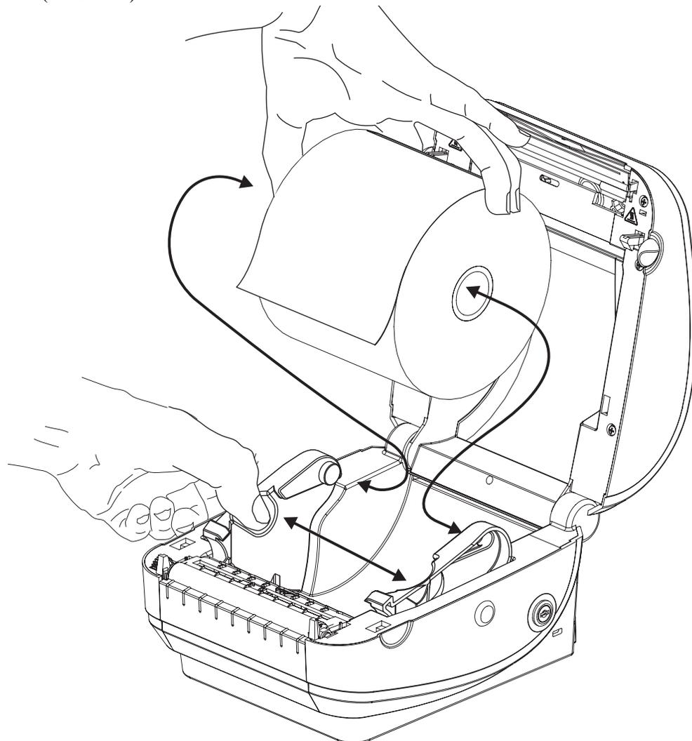
2. Tire del papel de manera que se extienda fuera del frente de la impresora. Verifique que el rollo gire libremente. El rollo no debe apoyarse en la parte inferior del compartimiento del papel. Verifique que la superficie de impresión del papel esté hacia arriba.
