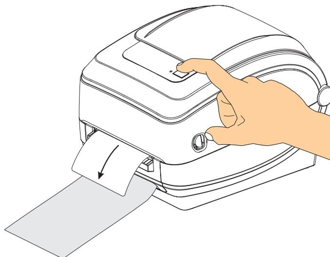
6. Durante o trabalho de impressão, a impressora removerá o forro e apresentará uma única etiqueta. Retire a etiqueta da impressora para permitir que a próxima etiqueta seja impressa. Observação: Se você não ativou o sensor de etiqueta removida para detectar a remoção da etiqueta distribuída (removida) com comandos de software, a impressora armazenará e ejetará etiquetas removidas.
