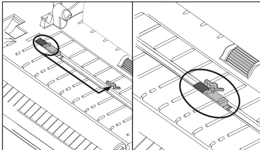
4. Passe a mídia pela fenda interna do cortador para que ela se estenda até a frente da impressora. Verifique se o rolo gira livremente. O rolo não deve se apoiar na base do compartimento de mídia. Verifique se a superfície de impressão da mídia está voltada para cima.
