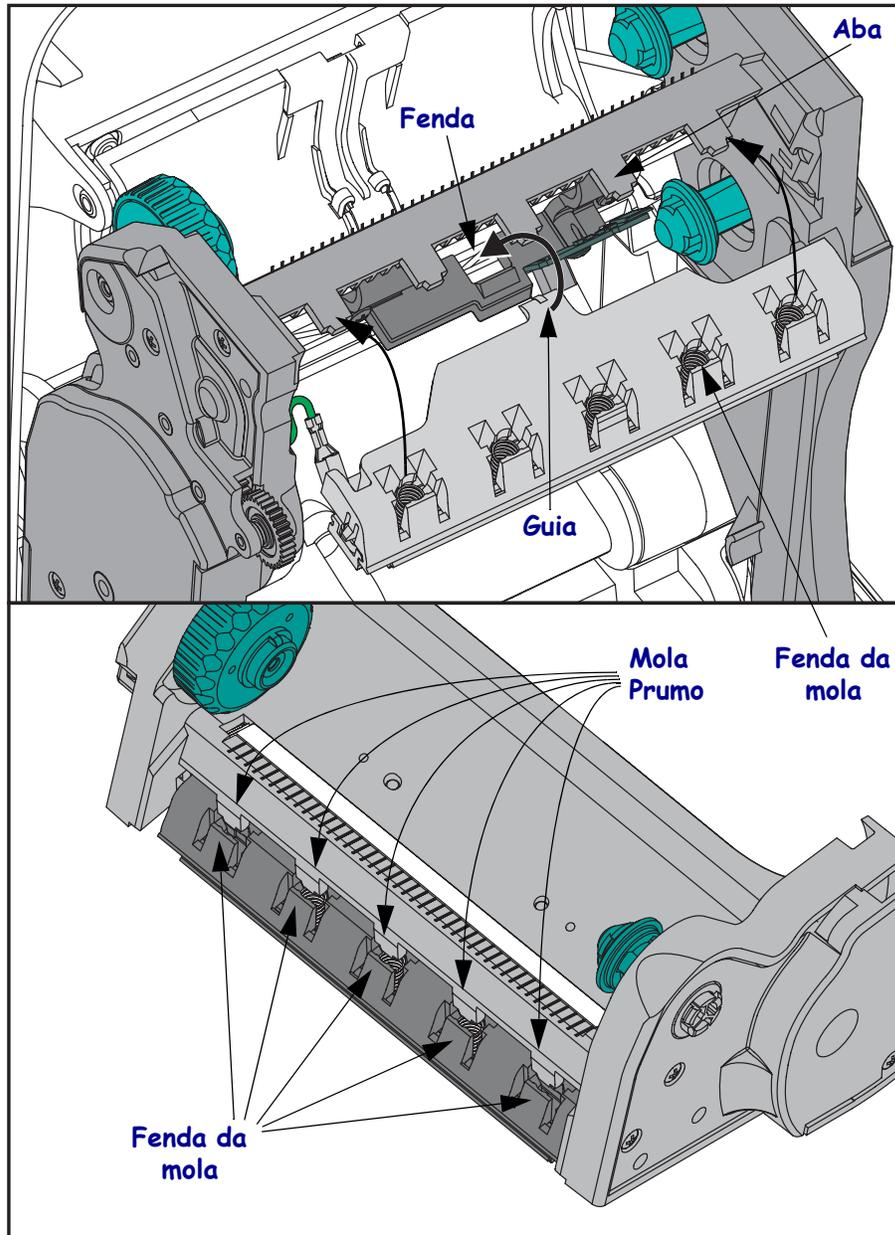
6. Coloque o lado esquerdo da guia da fita na moldura da fita. Desloque o lado direito da guia da fita na fenda e encaixe-a na posição.
