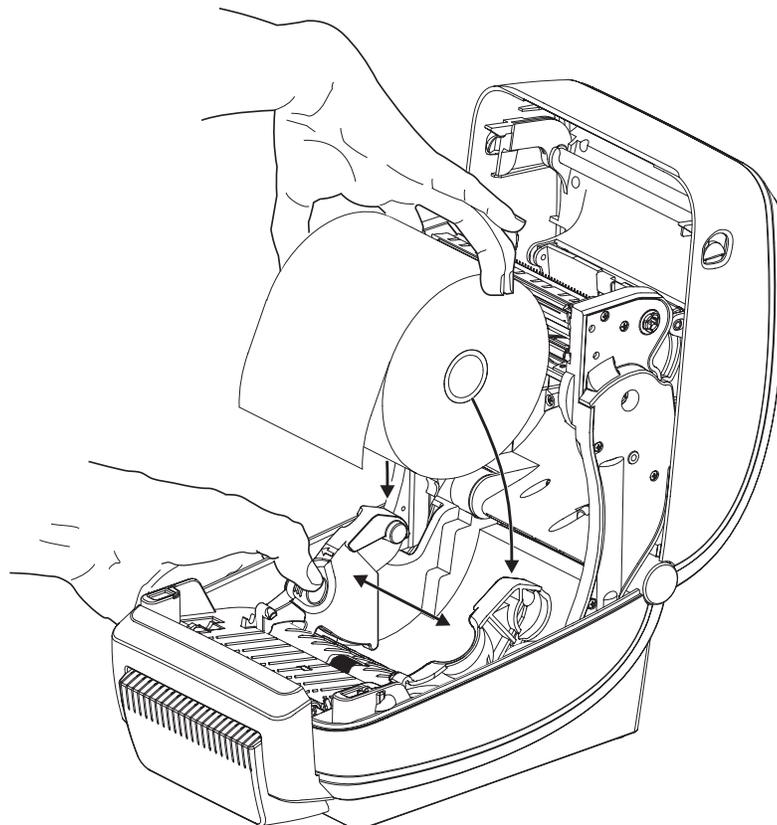
3. Se sua impressora incluir a opção de sensor móvel de marca preta, verifique se o sensor está alinhado ligeiramente à direita da posição padrão central. Essa é a posição de operação padrão para detecção de mídia. Quando o sensor for movimentado a partir da posição padrão, a impressora detectará apenas mídia marcada com linha preta, marca preta e ranhura.
