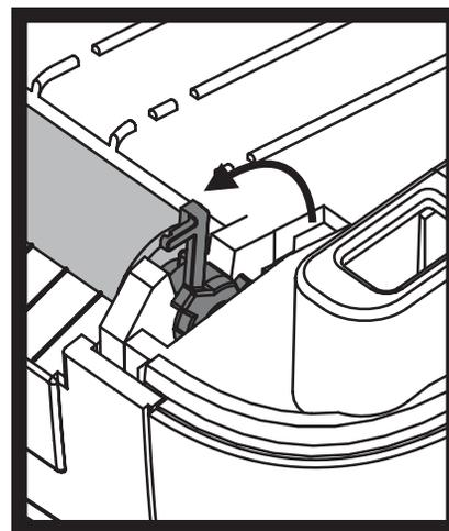
3. Levante o rolo de impressão para fora da armação base da impressora.
