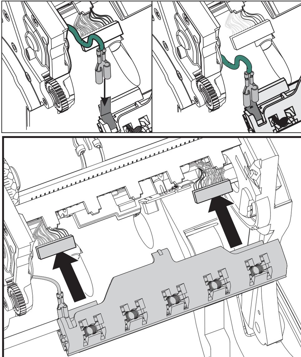
5. Insira a guia do suporte do cabeçote de impressão na fenda no conjunto da moldura da fita. Alinhe as fendas da mola do cabeçote de impressão às abas e encaixe o cabeçote de impressão na moldura da fita.
