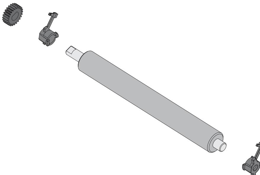
7. Alinhe o rolo de impressão com a engrenagem à esquerda e abaixe-o na direção da armação da base da impressora.
