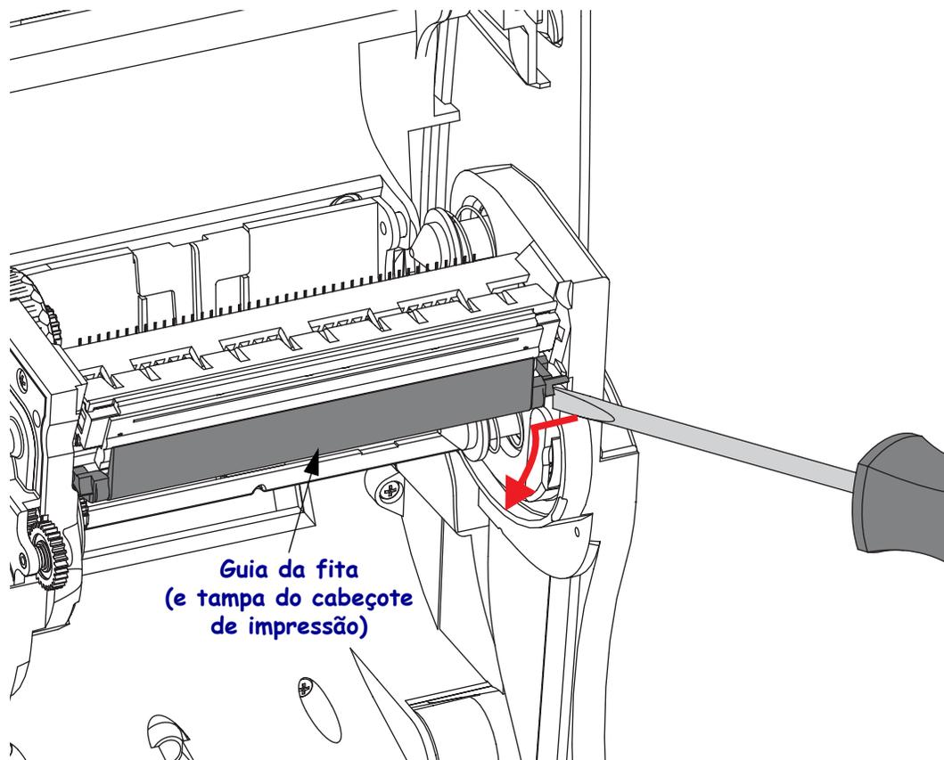
3. Use uma ferramenta sem corte para pressionar a guia de liberação no lado direito e, em seguida, no lado esquerdo do cabeçote de impressão. O diâmetro da ferramenta pode ser de 2,5 a 3,8 mm (0,10 a 0,15 polegadas).
