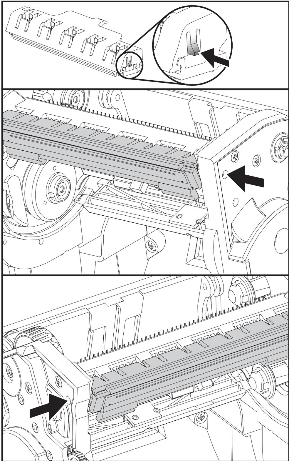
4. Desconecte com cuidado e firmeza os dois conectores dos grupos de cabos do cabeçote de impressão.
