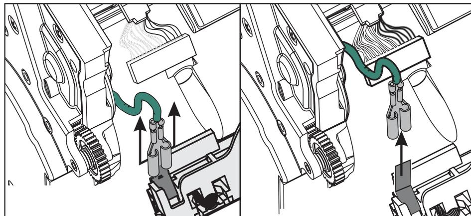
**Substituição do cabeçote de impressão**
