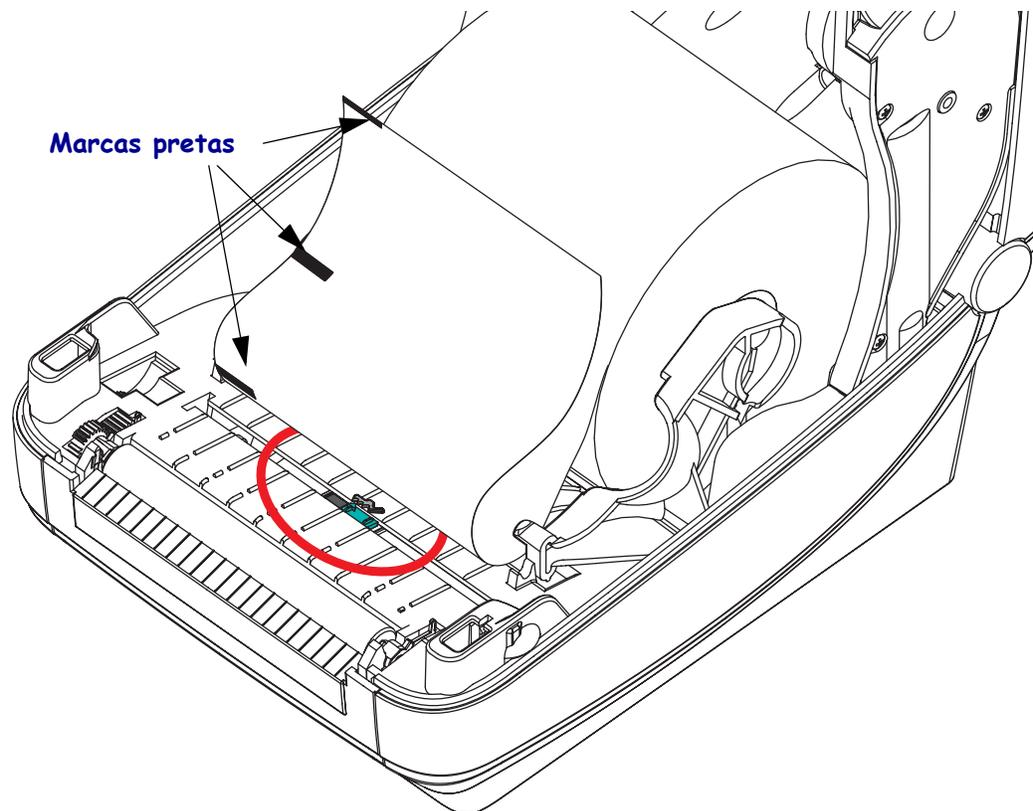
2. Deslize o sensor móvel da posição padrão central para alinhar com as marcas pretas. A seta no sensor móvel deve ficar alinhada com a borda direita da marca preta. Isso vale para marcas ou ranhuras localizadas nos dois lados da mídia (lado esquerdo mostrado).
