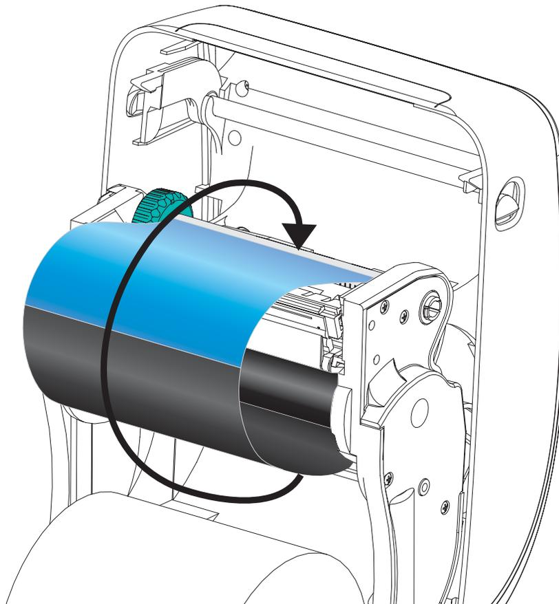
4. Gire a polia no lado esquerdo da bobina de suprimento em direção à parte posterior da impressora até que a fita esteja esticada ao redor do cabeçote de impressão.
