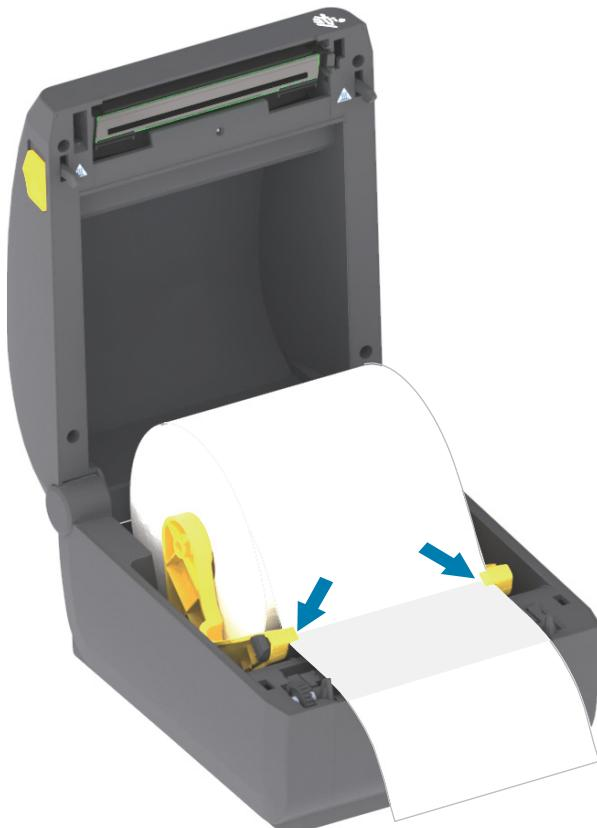
5. 用紙をめくり上げ、ご使用の用紙タイプに合わせて可動式用紙センサーの位置を調整します。
