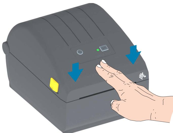
プリンタを用紙にキャリブレートする必要がある場合もあります。プリンタのセンサーは、ラベル、ライナーおよびラベル間の距離を検知して正常に動作するように調整する必要があります。同じ用紙 (サイズ、ベンダーおよびバッチ) を再装着したときは、フィード (前送り) ・ ボタンを 1 回押して用紙の印刷準備ができます。
