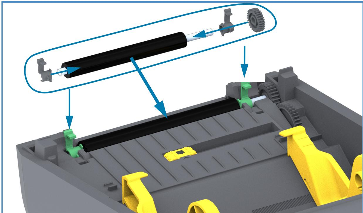
8. プラテンを左側のギアに合わせて、プリンタの底フレームに下ろします。
