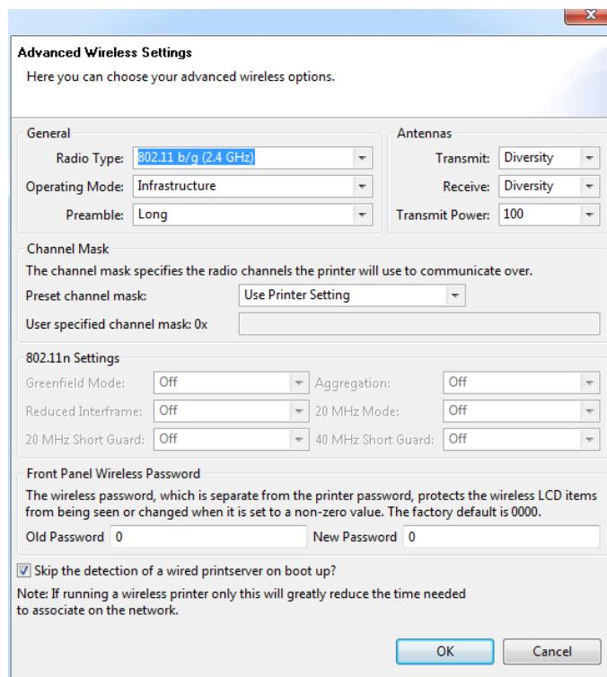
13. 「Advanced Wireless Settings (詳細ワイヤレス設定)」 ウィンドウの設定を確認します。必要に応じて設定を変更し、続いて「OK」をクリックします。「Wireless Settings (ワイヤレス設定)」 ウィンドウに戻ります。
