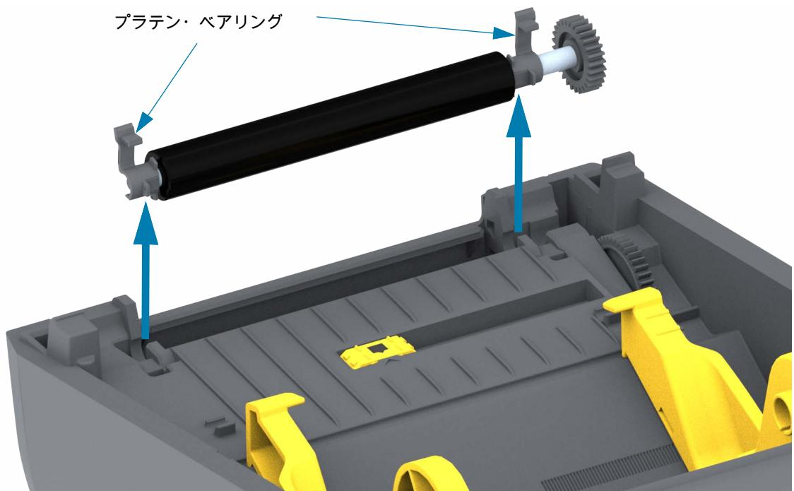
4. ギアと 2 個のベアリングをスライドさせてプラテン・ローラーのシャフトを取り外します。
