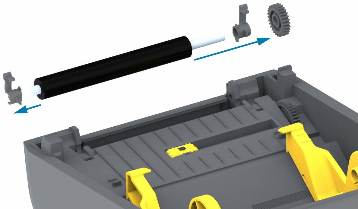
5. クリーニングのみ — アルコールで湿らせた綿棒でプラテンをクリーニングします。中央から外側に向かって拭きます。ローラーの表面が完全にきれいになるまで、このプロセスを繰り返します。粘着物の蓄積やラベルのジャムがひどい場合は、新しい綿棒でクリーニングを繰り返して残った汚れを除去してください。たとえば、1回のクリーニングでは粘着物や油が薄くなっても、完全には取り除けないことがあります。
