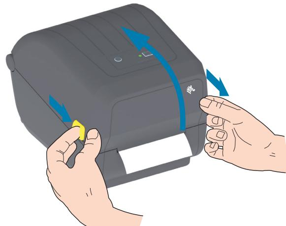
2. 用紙ロール・ホルダーを開きます。ロール紙がプラテン (ドライブ)・ローラーを通るとき、印刷される面が上向きになるように用紙ロールの向きを定めます。用紙ガイドを空いている方の手で引いて開き、用紙ロールをロール・ホルダーに載せたらガイドから手を放します。ロールがスムーズに回転することを確認します。ロールが用紙セット部の底で動かない状態になつてはなりません。
