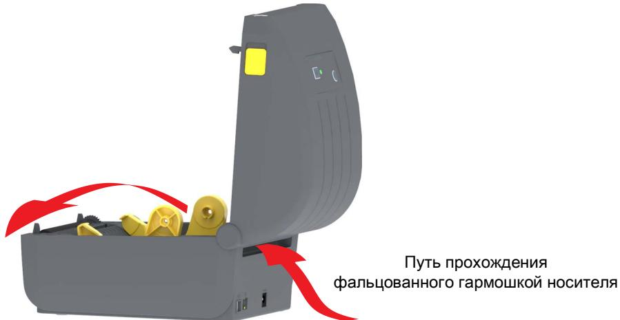
2. Отрегулируйте положение направляющих носителя при помощи регулировочного колесика золотистого цвета с накаткой. Для регулировки положения направляющих воспользуйтесь отдельным листом носителя. Чтобы раздвинуть направляющие, вращайте колесико от себя. Чтобы сдвинуть направляющие, вращайте колесико на себя.
