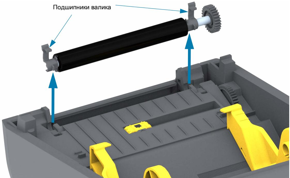
4. Снимите шестерню и два (2) подшипника с оси опорного валика.
