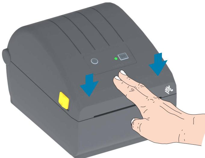
Может потребоваться выполнить калибровку принтера в соответствии с носителем. Необходимо настроить датчики принтера, чтобы считывание этикеток, подложки и расстояния между этикетками работало правильно. В случае загрузки идентичного носителя (размер, поставщик и партия) для подготовки носителя к печати достаточно просто один раз нажать кнопку ПОДАЧА.
