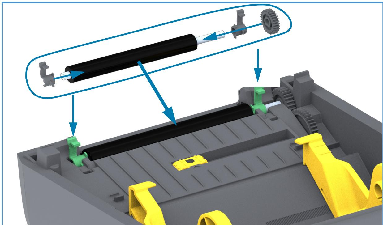
8. Выровняйте опорный валик по шестерне слева и опустите его в нижнюю часть корпуса принтера.
