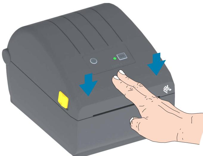
Možda će biti potrebno da kalibrišete svoj štampač za medije. Senzori štampača treba da se podese za detektovanje nalepnice, nosača i razdaljine između nalepnica da bi pravilno radili. Kada ponovo ubacujete isti medij (veličina, proizvođač i serija), možete samo jednom da pritisnete dugme FEED (Advance) (Uvuci (Nastavi)) da biste pripremili medij za štampanje.
