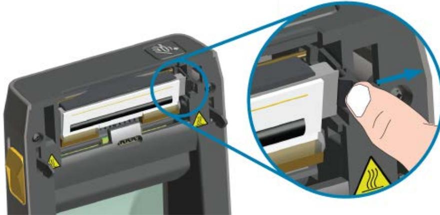
4. Gire el lado derecho suelto del cabezal de impresión para sacarlo de la impresora. Térelo un poco hacia la derecha para liberar el lado izquierdo del cabezal de impresión. Tire del cabezal de impresión hasta acceder a sus cables conectados.
