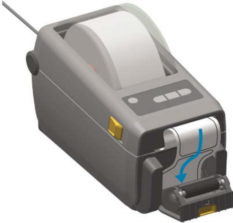
4. Cierre la tapa del dispensador mientras tira del extremo del recubrimiento de la etiqueta firmemente.
