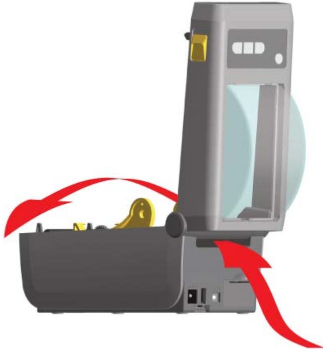
2. Ajuste la posición de tope de la guía de medios con la rueda de control dorada. Utilice un trozo del medio plegado en abanico para establecer la posición de tope. Gire la rueda en dirección contraria a usted a fin de ampliar las guías. Gire la rueda hacia usted para que las guías de medios sean más estrechas.
