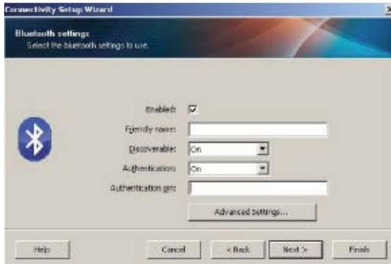
Si el dispositivo principal utiliza BT v2.1 o versiones más recientes, esta configuración no tiene efecto. BT v2.1 y las versiones más recientes utilizan el emparejamiento simple seguro (SSP), que no requiere el uso de un PIN.
