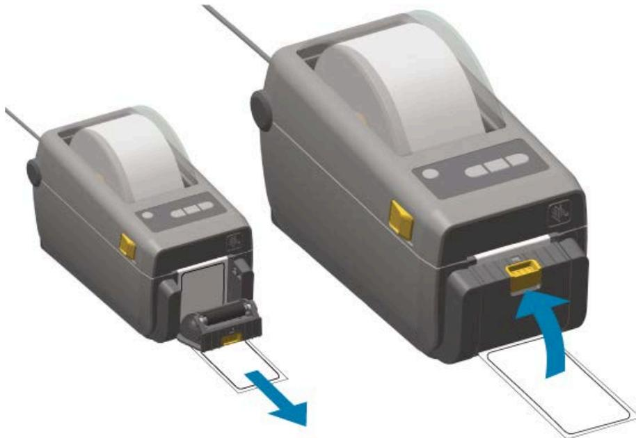
5. Presione y suelte **FEED** (ALIMENTAR) (
