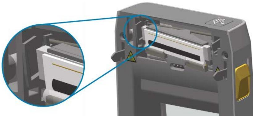
6. Empuje el lado derecho del cabezal de impresión hacia la impresora hasta que el pestillo bloquee el lado derecho del cabezal de impresión en la impresora.
