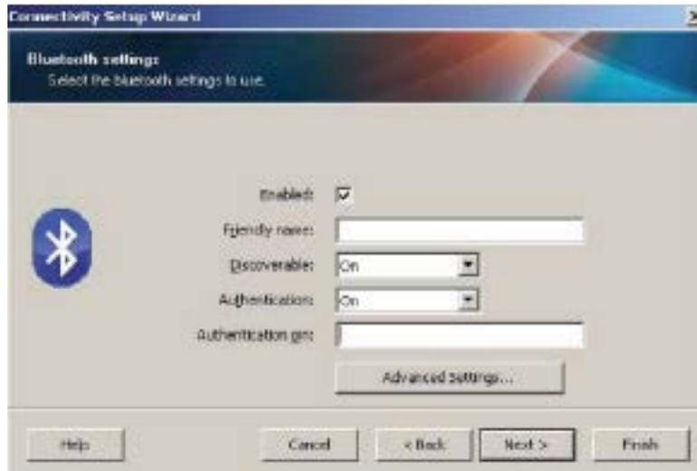
Se il dispositivo principale utilizza BT v2.1 o versioni successive, questa impostazione non ha alcun effetto. BT v2.1 e versioni successive utilizzano SSP (Secure Simple Pairing) che non richiede l'uso di un PIN.
