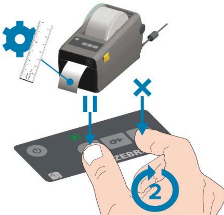
Al termine dell'operazione SmartCal, la stampante misura alcune etichette e regola i livelli di rilevamento dei supporti. Quando la stampante si arresta, l'indicatore di stato (🟡) diventa di colore verde fisso.
