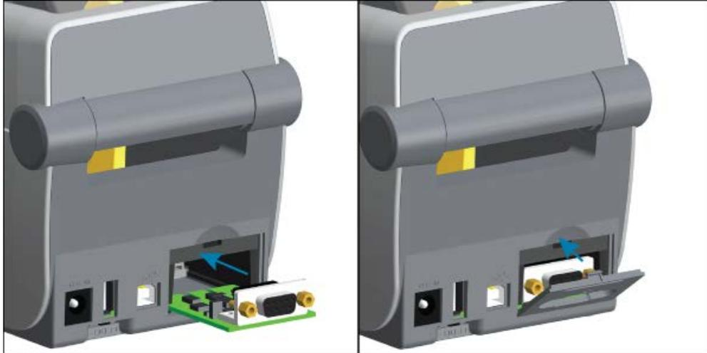
2. Allineare la parte inferiore del coperchio dello sportello della porta seriale al bordo inferiore dell'apertura di accesso al modulo. Ruotare lo sportello verso l'alto e chiuderlo con uno scatto.
