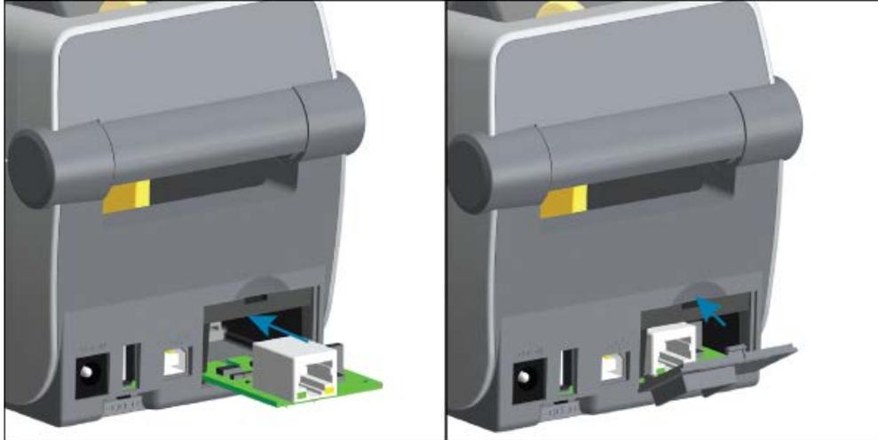
2. Allineare la parte inferiore del coperchio dello sportello della porta Ethernet al bordo inferiore dell'apertura di accesso al modulo. Ruotare lo sportello verso l'alto e chiuderlo con uno scatto.
